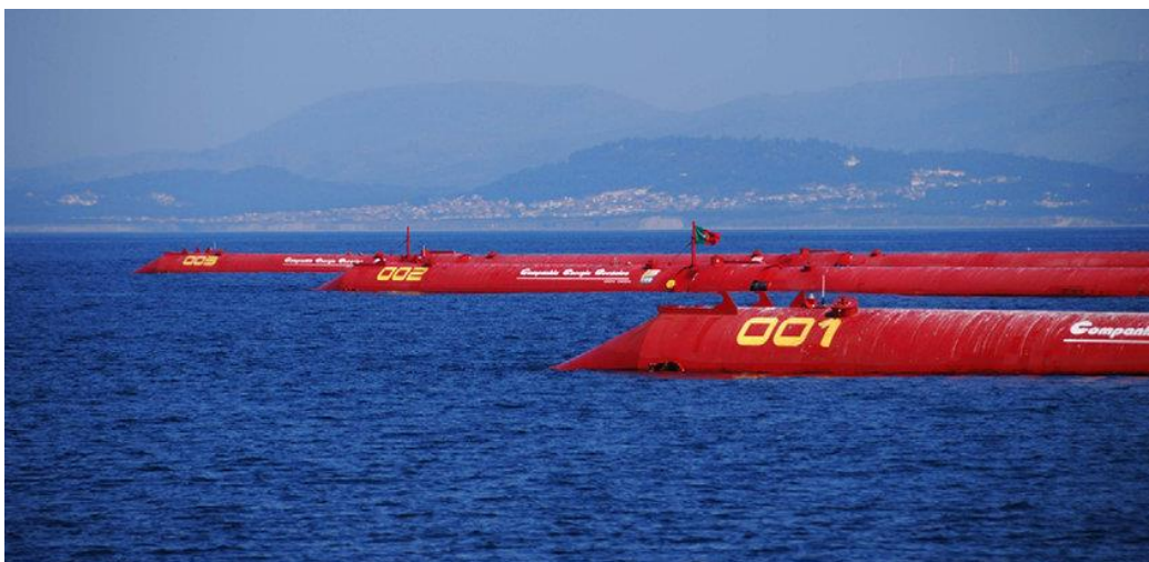
SI. 3.27. Prikaz 3 spojena Pelamis uređaja, Portugal
