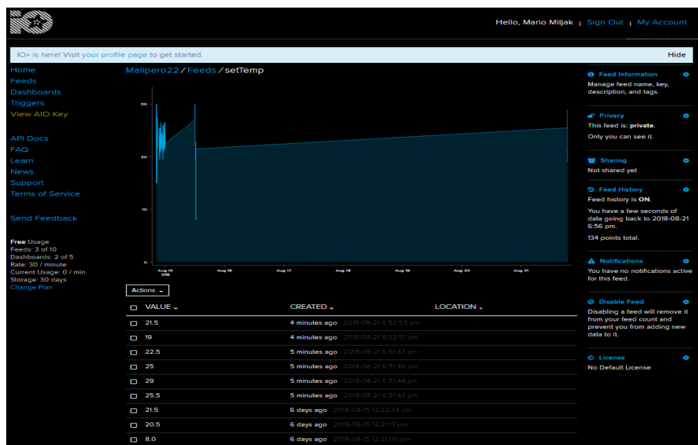
Sl. 4.14. Kreirana grupa podataka „setTemp“ unutar Adafruit IO oblak usluge.
