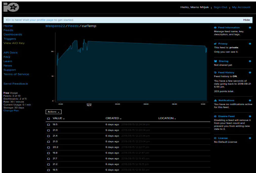
Sl. 4.13. Kreirana grupa podataka „curTemp“ unutar Adafruit IO oblak usluge.
