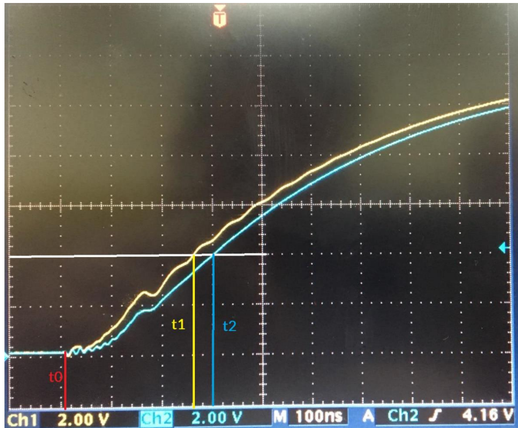
Slika 5.6 Upravljački signali pri dodanom otporu od 10 \Omega .
