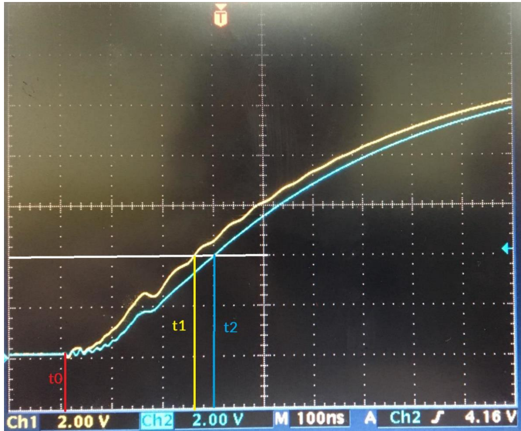
Slika 5.6 Upravljački signali pri dodanom otporu od 10 Ω.
