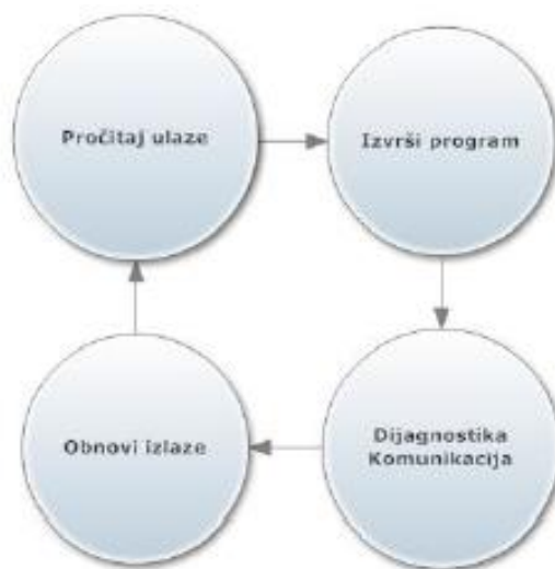
Slika 3.1. Princip rada PLC-a
