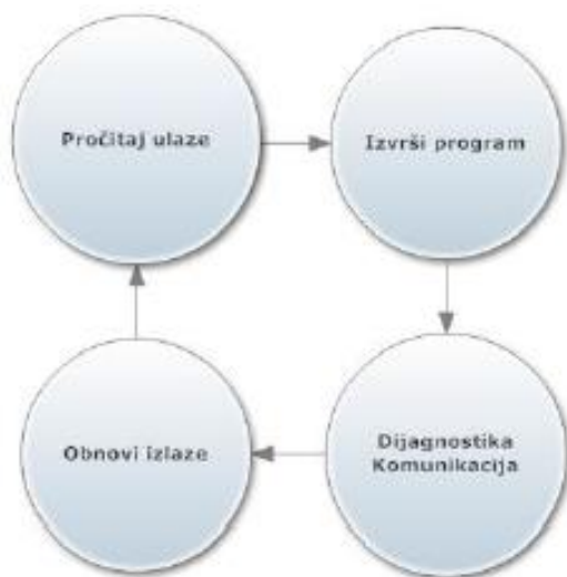
Slika 3.1. Princip rada PLC-a
