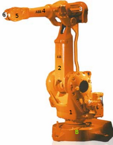
Slika 3.1 Korišten robotski manipulator sa označenim člancima
