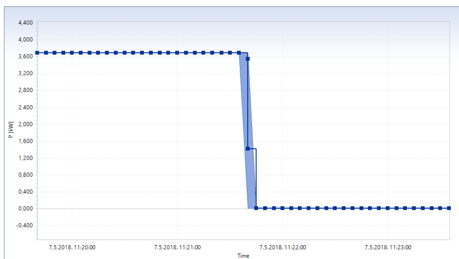
Slika 8.9. Prikaz mjerenja snage P u fazi L1
