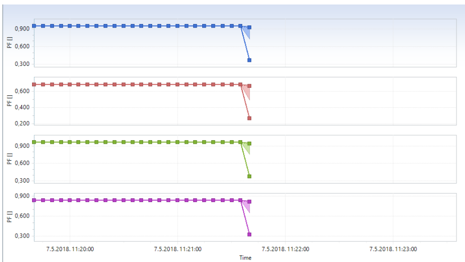
Slika 8.13. Prikaz faktora snage sve tri faze i ukupan faktor snage ( \cos \varphi_{cap} )
