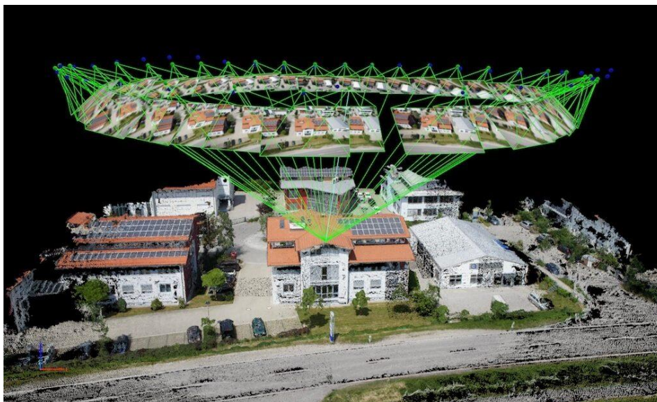
Sl. 4.2. Slika 3D zračnog mapiranja građevine [16]
