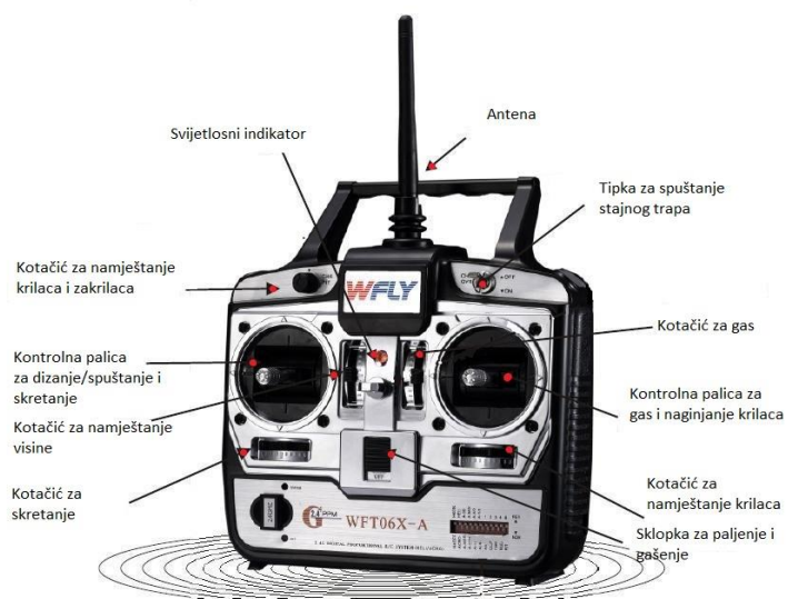
Sl. 3.8. Slika radio stanice WFT06X-A [14]
