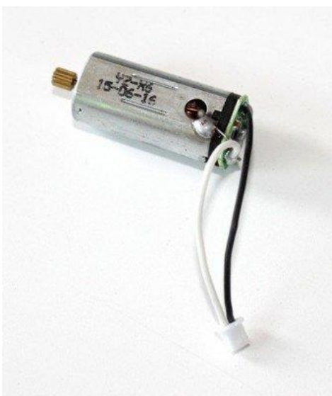
Sl. 3.6. Slika motora drona CCV JJRC Tarantula X6 [13]
