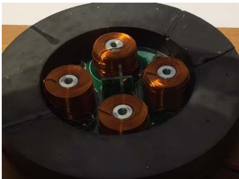
Slika 5.1. Sustav za levitaciju
