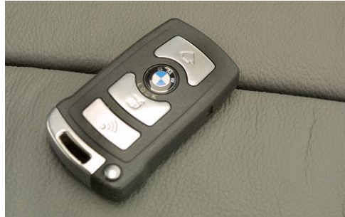
Sl. 2.5. BMW-ov prototip pametnog ključa.
