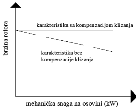
Slika 4.1. Karakteristika ovisnosti brzine vrtnje o opterećenju asinkronog motora [15]
