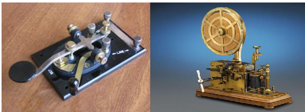
Sl. 2.2: Originalni Morseov koder i dekoder.
