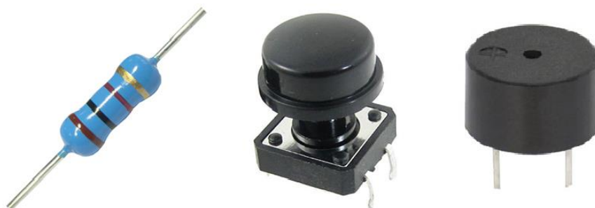
Sl. 3.4: Otpornik, tipkalo i zujalica.
