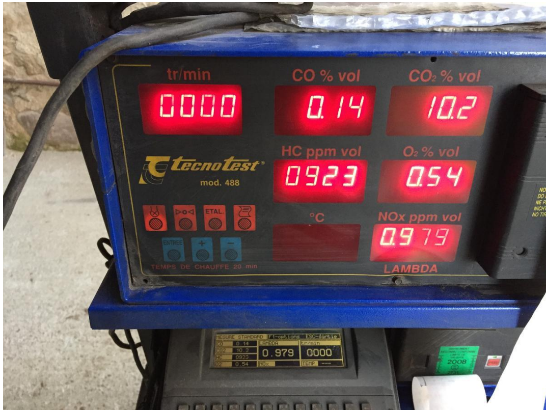
Sl. 2.28. – Primjer rezultata odrađenog testa ispušnih plinova [23]
