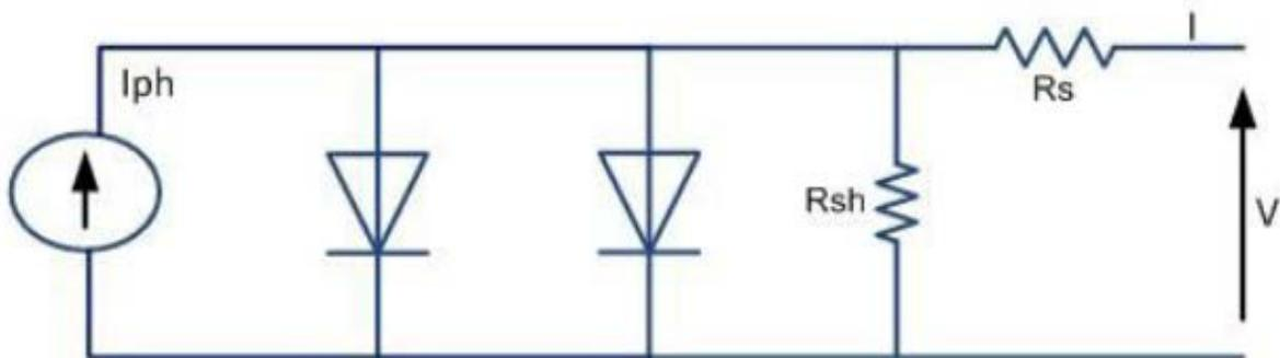
**Slika 4.7.** Nadomjesna shema fotonaponskog sustava sa dvije diode
