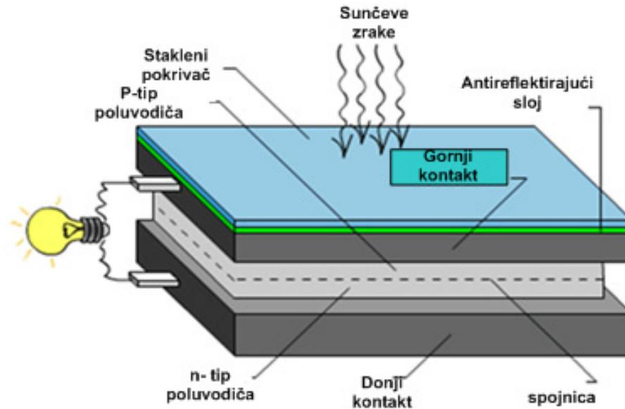
**Slika 2.3.** Osnovni prikaz fotonaponske ćelije [3]
