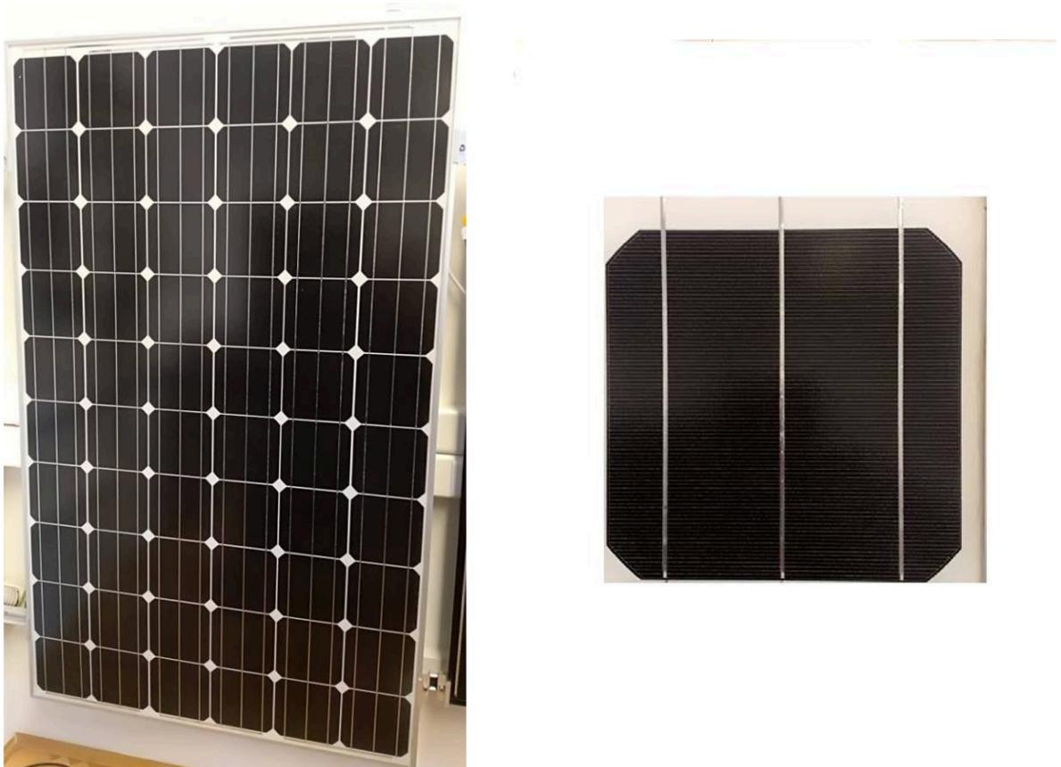
**Slika 2.4.** Solarni modul i ćelija- monokristalni silicij
