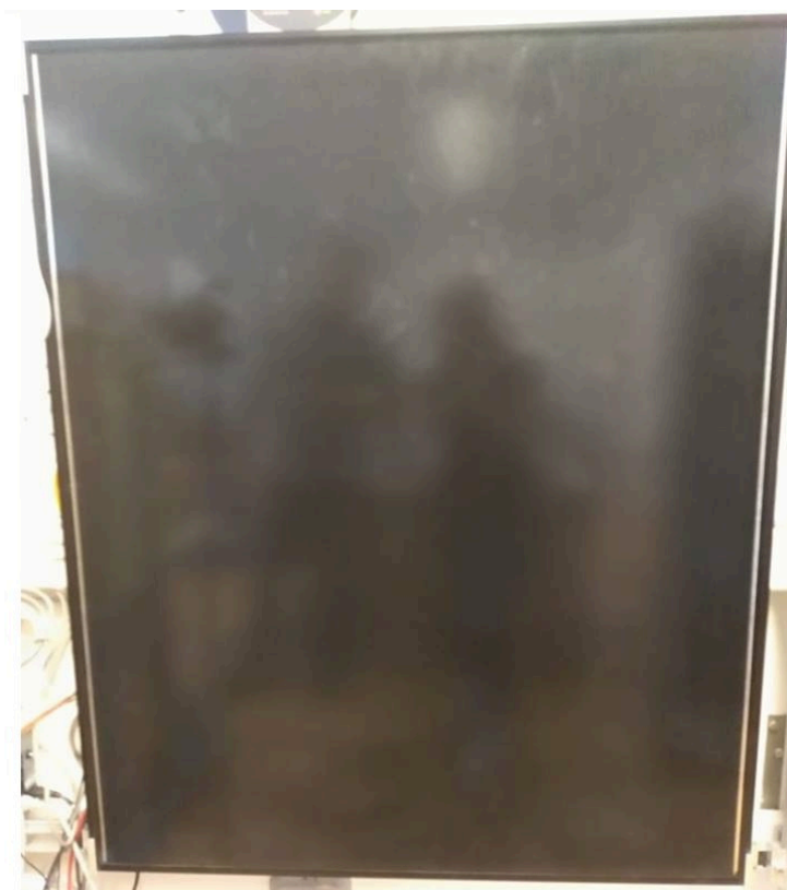
Slika 2.7. Solarni modul- tankoslojni modul
