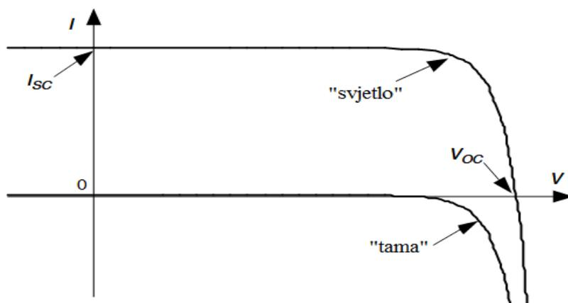
**Slika 4.6.** Strujno-naponski odnos fotonapona za „tamu“ (bez sunčeva svjetla) i za „svjetlo“ (osvijetljena ćelija) [18]
