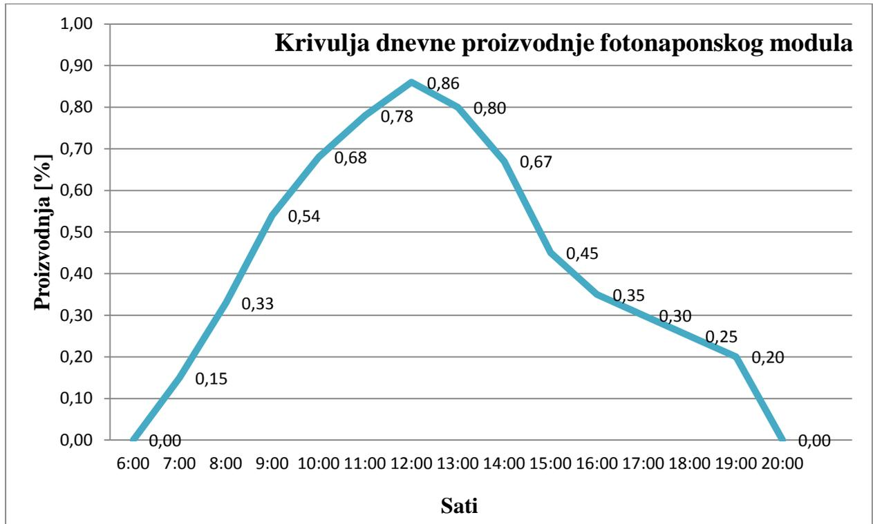
**Slika 4.18.** *Krivulja dnevne proizvodnje fotonaponskog modula*
