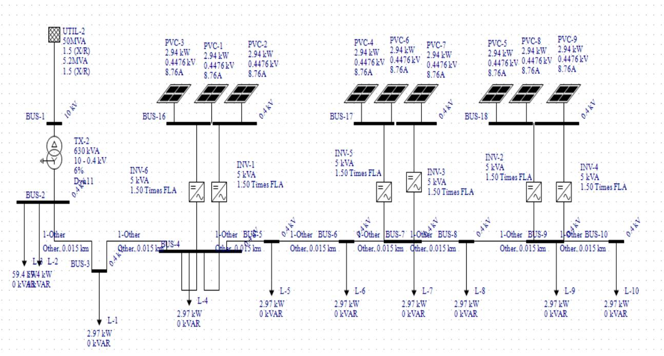
Slika 4.15. Model fotonaponskog sustava
