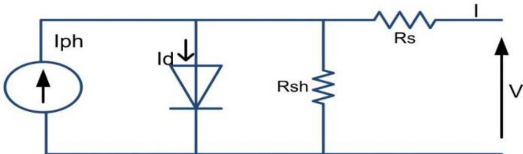
**Slika 4.1.** Nadomjesna shema fotonaponskog sustava sa jednom diodom
