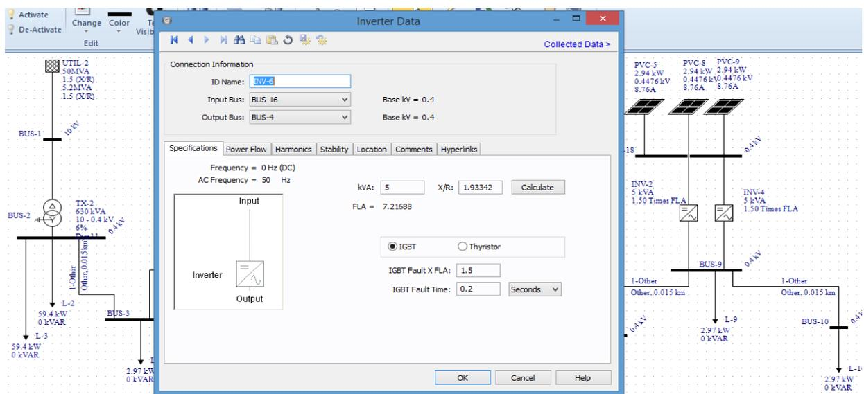
Slika 4.17. Ulazni podaci za inverter
