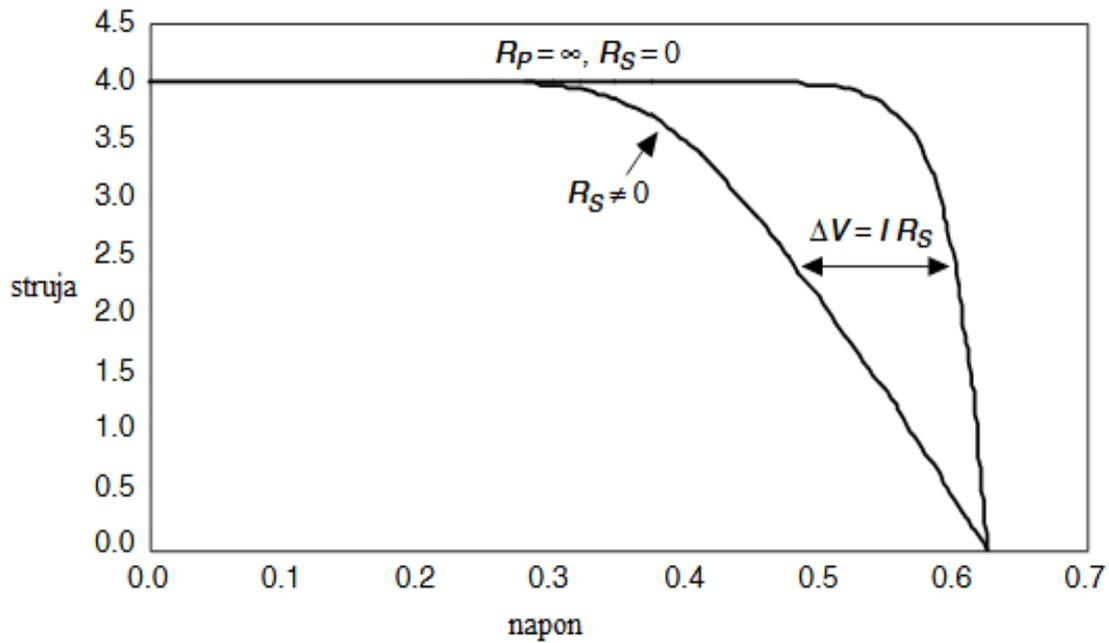
**Slika 4.12.** Strujno naponska karakteristika fotonaponskog modela nastala dodavanjem otpora u seriju [18]
