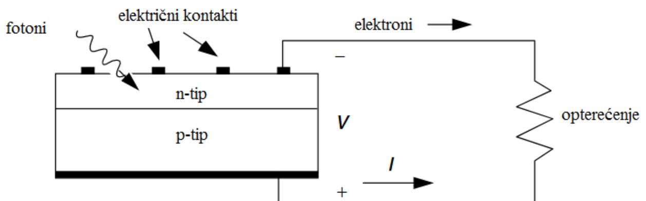
**Slika 4.3.** Fotonaponska ćelija [18]
