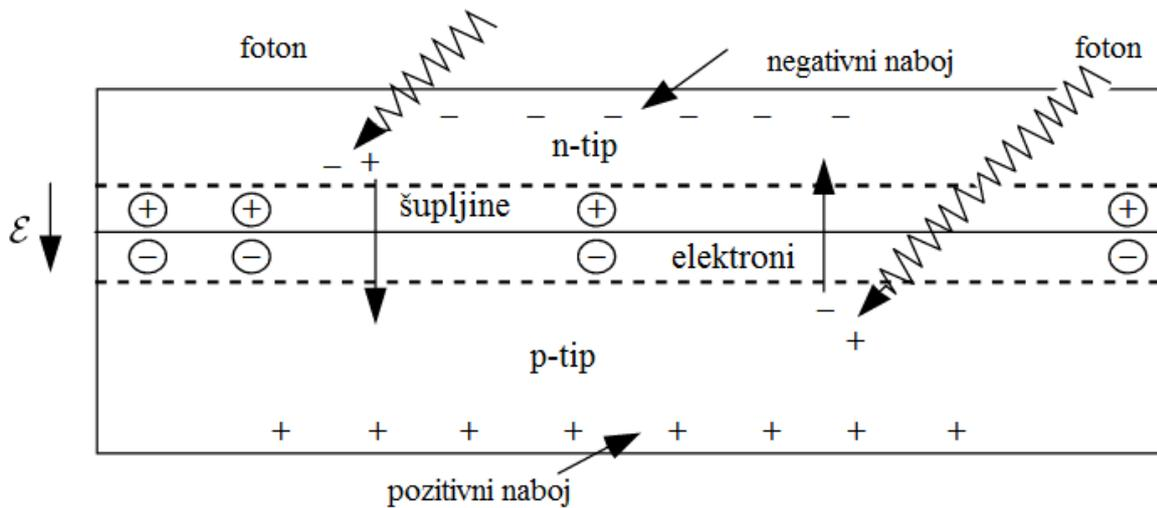
**Slika 4.2.** Prikaz fotonaponske ćelije [18]
