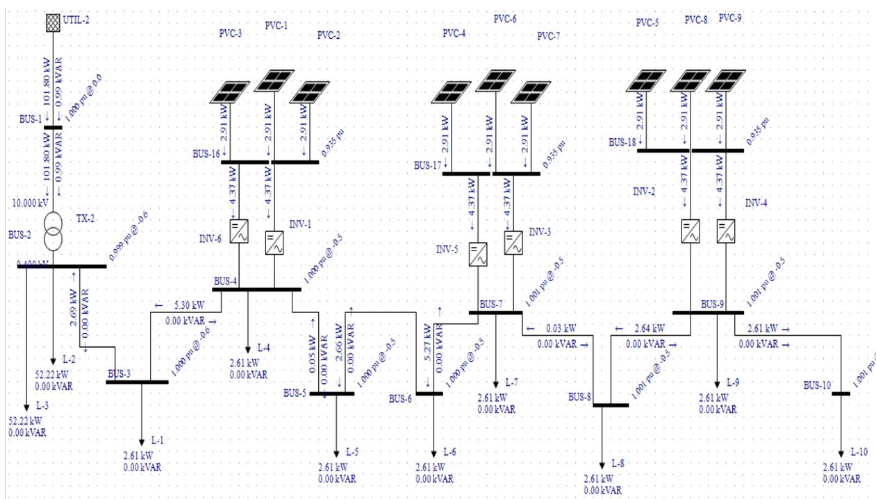
**Slika 4.22.** Simulacija sustava za 12:00h
