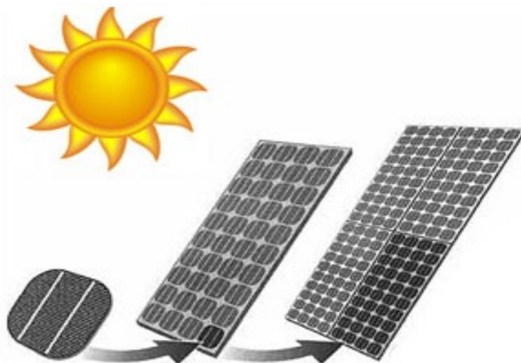
**Slika 2.2.** Prikaz fotonaponske ćelije, modula i panela [5]
