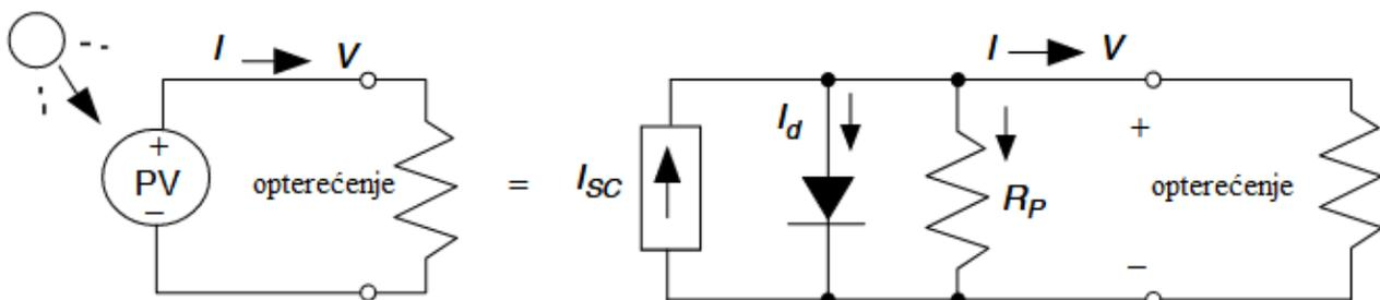
**Slika 4.9.** Jednostavni ekvivalentni krug sa paralelno dodanim otporom  $R_p$  [18]
