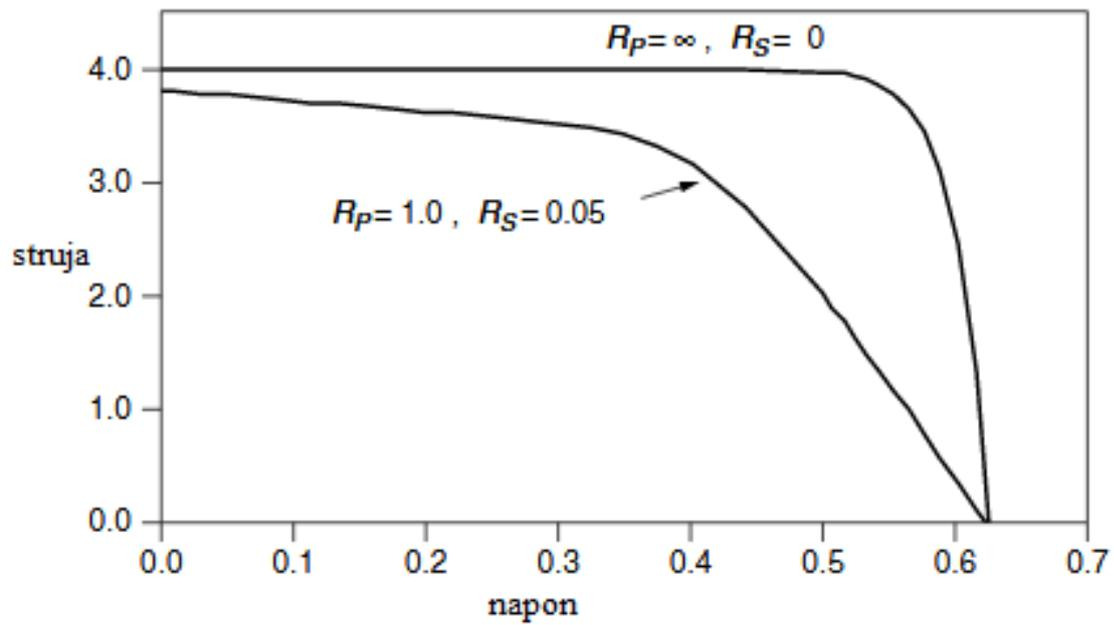
**Slika 4.14.** Strujno naponska karakteristika fotonaponskog modela nastala dodavanjem otpora *i u paralelu i u seriju*
