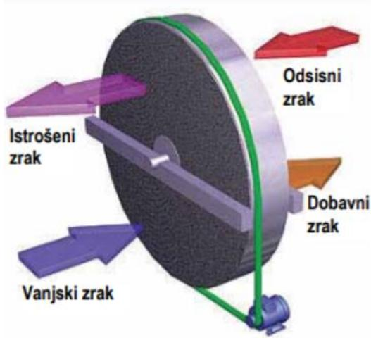
Slika 3.12Princip rada [15]
