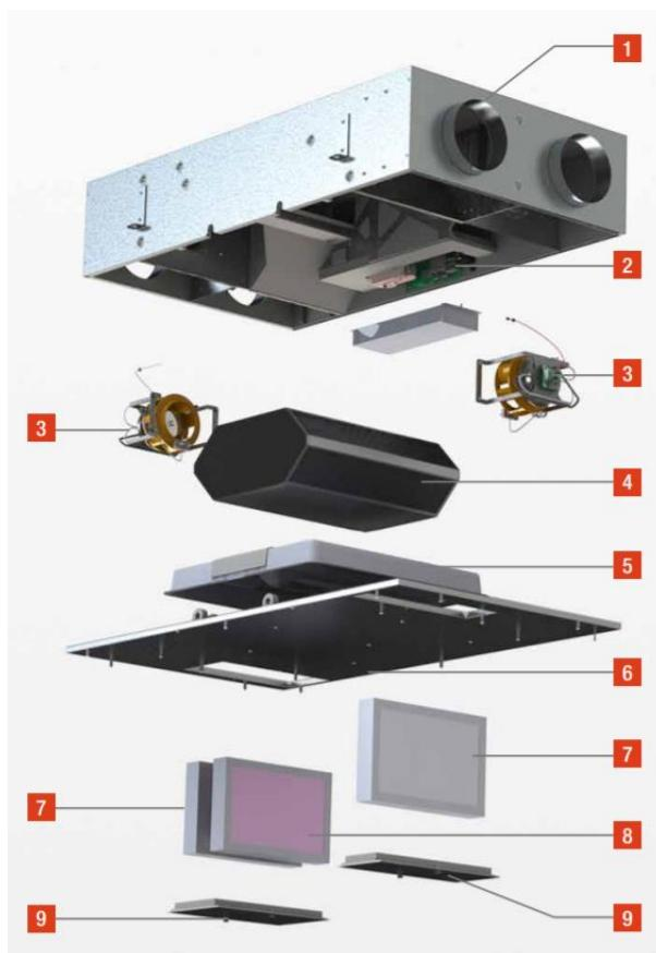
**Slika 3.2 Komponente rekuperatora [17]**
