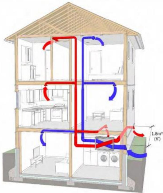
**Slika 3.20**Primjer centraliziranog sustava u stambenoj kući [16]
