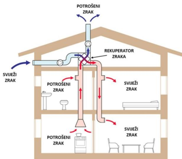
**Slika 3.1**Sustav ventilacije sa rekuperatorom u stambenoj kući [5]
