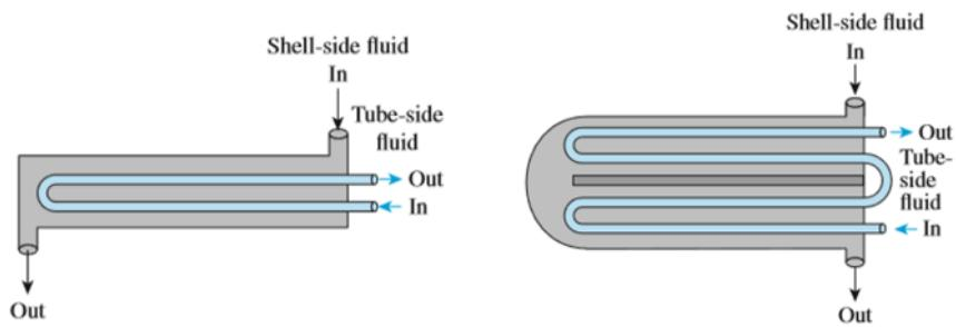
**Slika 3.9** Primjeri izmjenjivača (Shell-and-tube) sa više prolaza fluida; prvi broj označava broj prolaza kroz plašt izmjenjivača, a drugi broj prolaza kroz cijevi,
