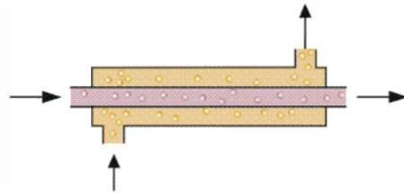
**Slika 3.5** Shematski prikaz istosmjernog toka fluida [8]
