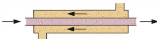
**Slika 3.3** Shematski prikaz protustrujnog toka fluida [8]
