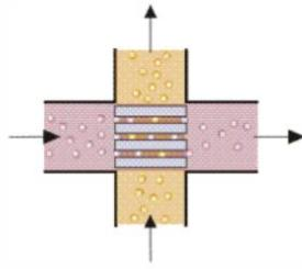
**Slika 3.7** Shematski prikaz križnog toka fluida [8]
