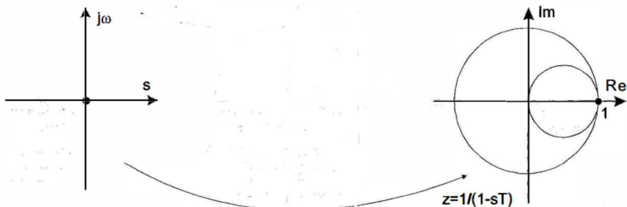
Slika 2.5. Preslikavanje iz s ravnine u Euler kauzalnom diferencijom [3, str.659].
