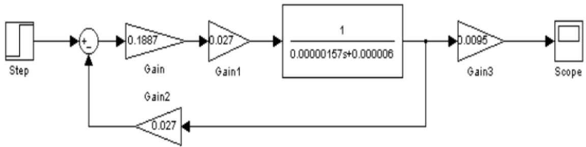
Slika 3.3. Simulacijski model servomotora s vrijednostima iz Tablice 3.2.
