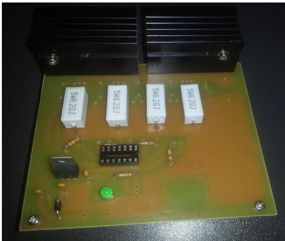
Sl. 5.2. Slika prikazuje nekoliko polemljenih elemenata, te se mogu vidjeti prazna mjesta koja su predviđena za preostale elemente
