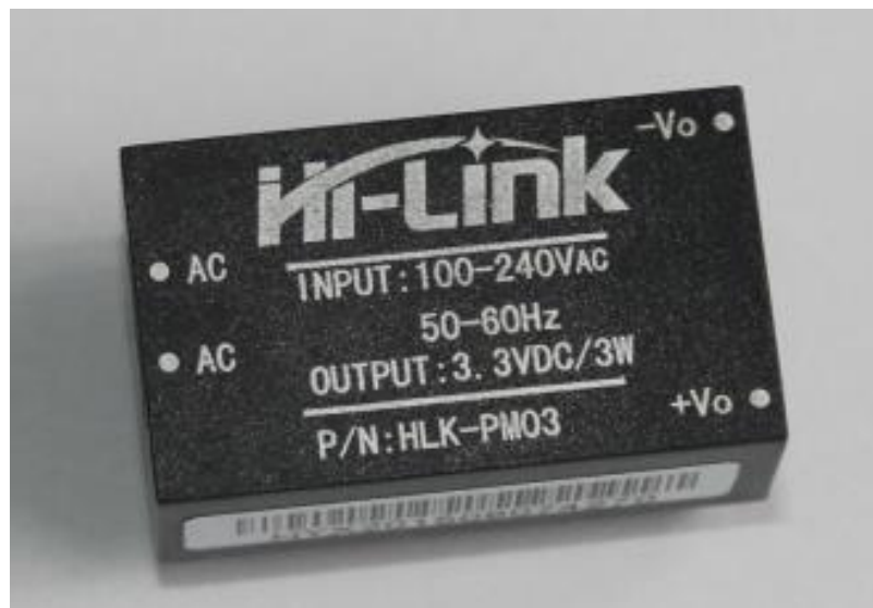
Slika 2.1. Hi-Link HLK-PM03 AC/DC pretvarač [2]
