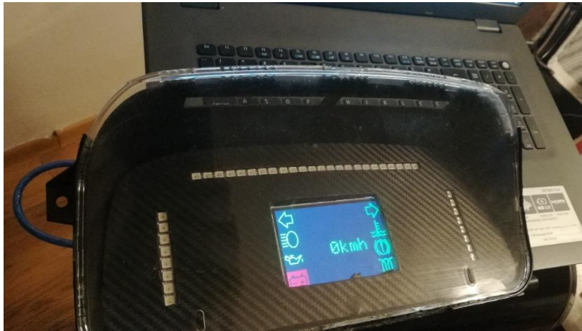
Slika 4.27. – Prikaz završenog panela uključenog u USB konektor
