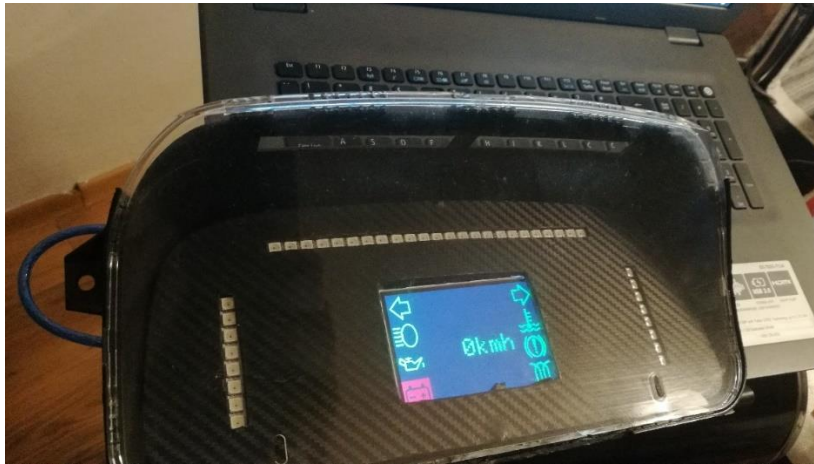
Slika 4.27. – Prikaz završenog panela uključenog u USB konektor
