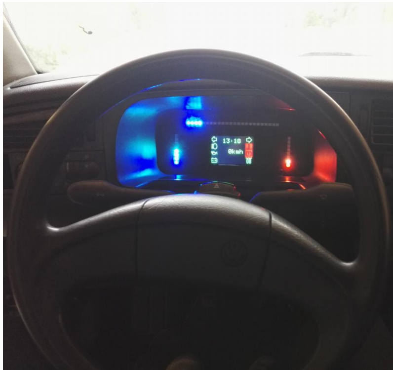
Slika 4.28. - Prikaz ugrađenog i funkcionalnog zadanog automobilskog panela u automobilu
