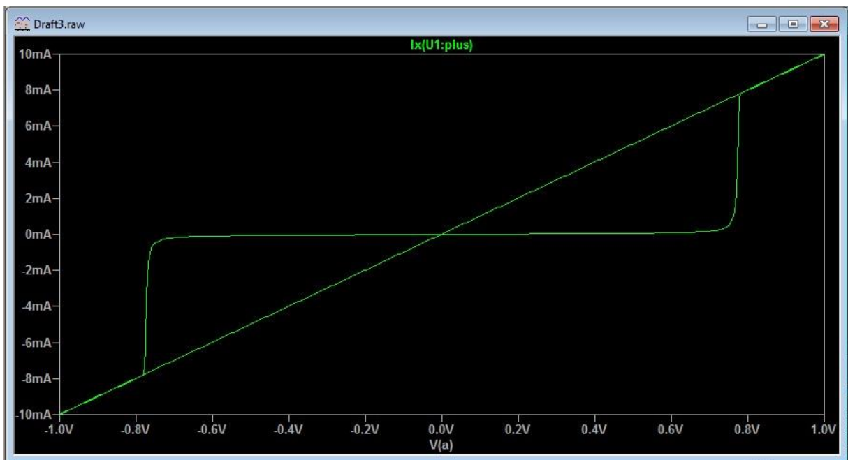
4.18. Strujno-naponske karakteristike Biolek memristora pri frekvenciji od 0,1Hz
