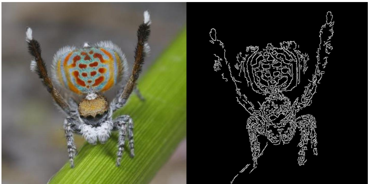
Slika 2.2. Ulaz(lijevo) i izlaz(desno) Canny algoritma[3]
