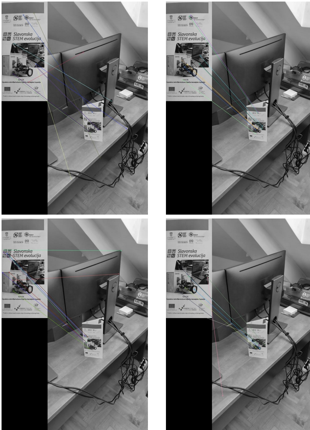
Slika 4.9. Rezultati na slici: gore lijevo FREAK, gore desno BRISK, dolje lijevo SIFT, dolje desno SURF
