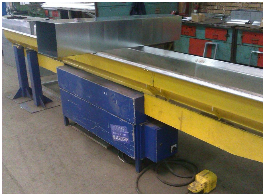
Slika 6.1 – Stroj za spajanje šavova cijevi
