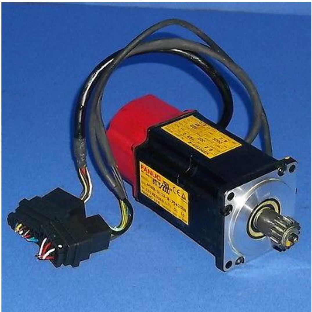
Sl. 4.10. Motor za X i Z osi model Fanuc α8βi.
