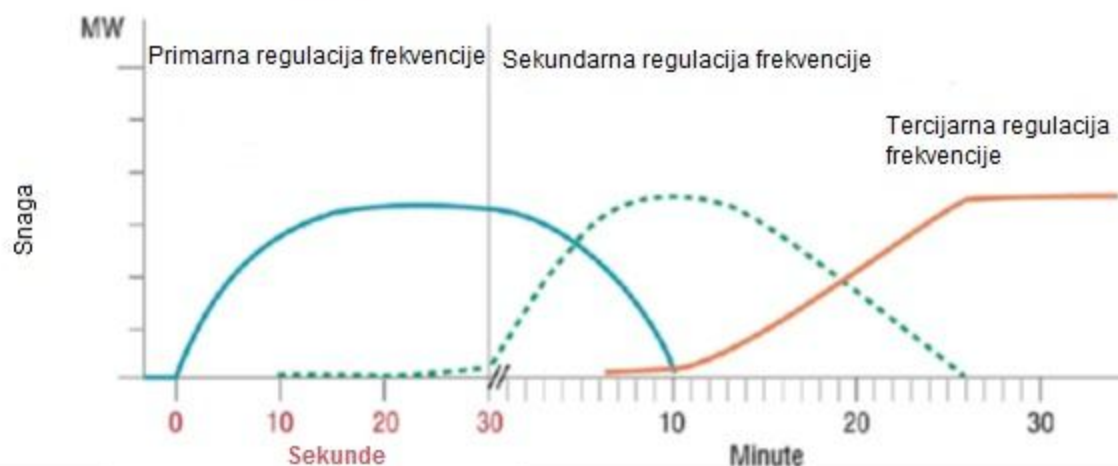
Slika 2.4 Prikaz uspostave frekvencije mreže nakon disbalansa
