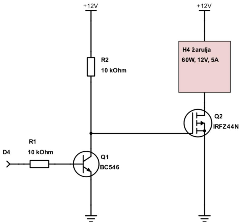
Slika 3.3. Shema spajanja žarulje na arduino
