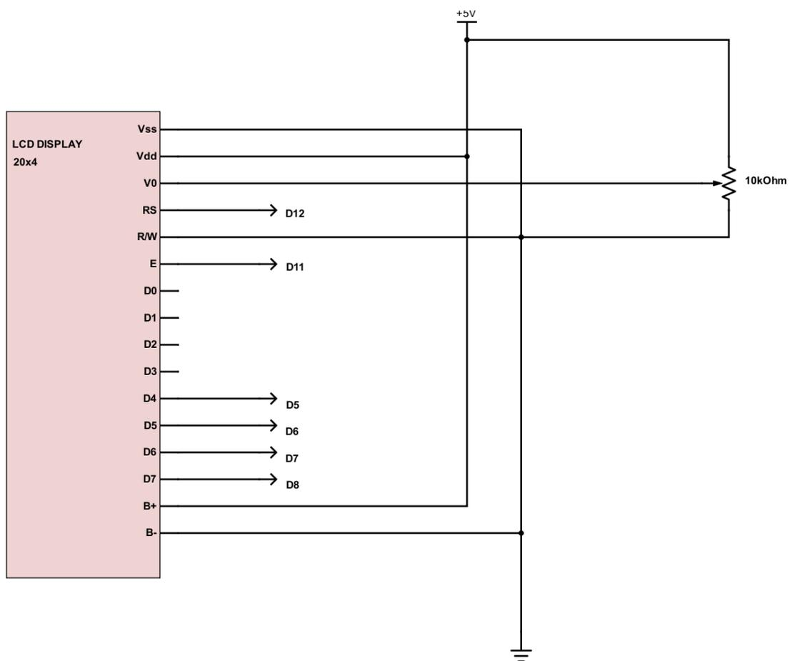
Slika 3.11. Shema spajanja LC ekrana sa Arduinoom
