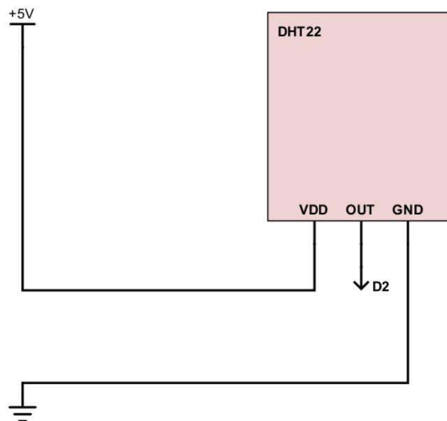
Slika 3.1. Shema spajanja DHT22 senzora sa Arduinom
