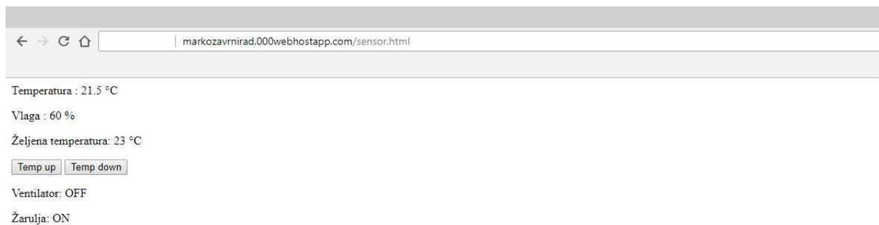
*Slika 3.15. Izgled web servera za prikaz temperature i vlage preko Wi-Fi-a*
