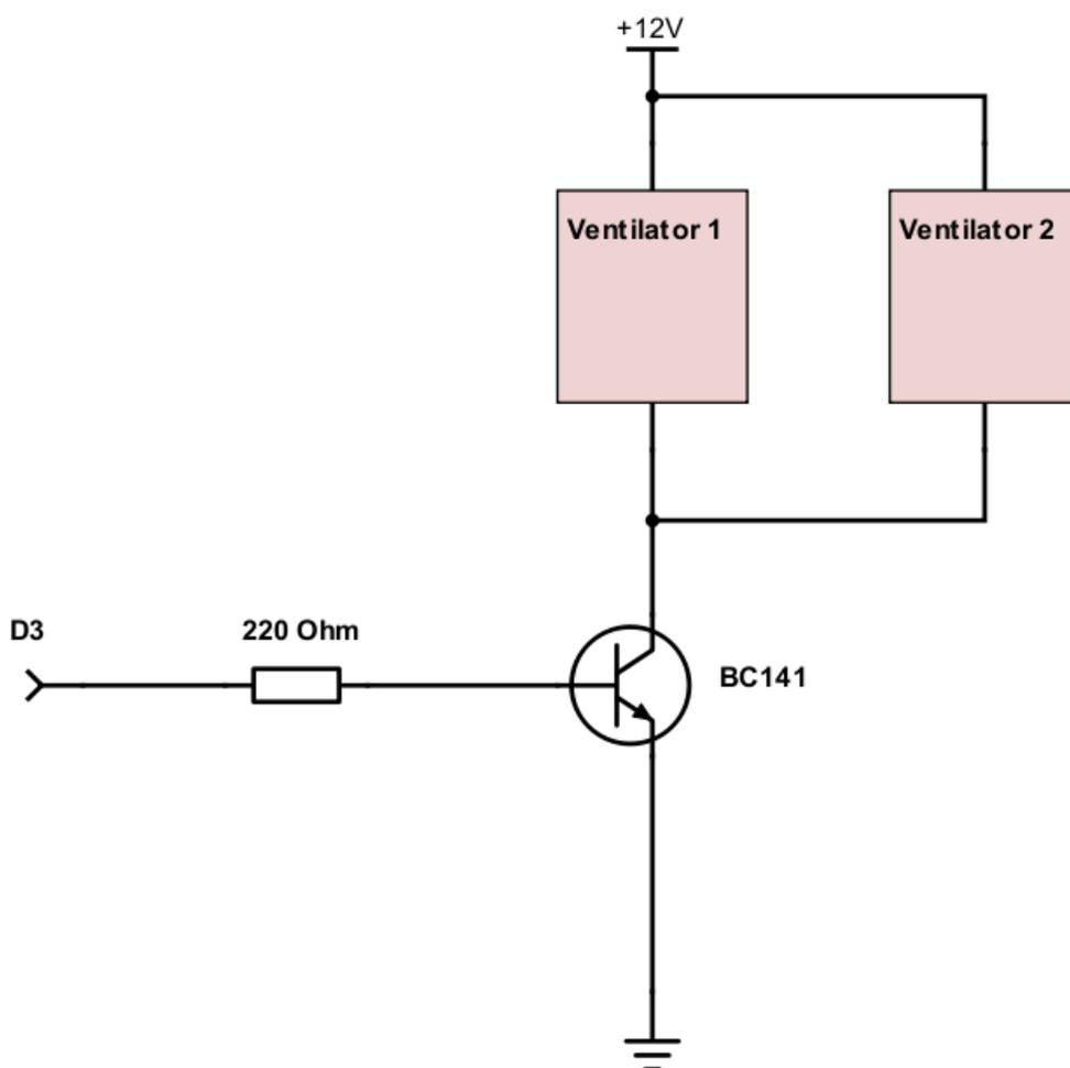
Slika 3.2. Shema spajanja ventilatora na arduino
