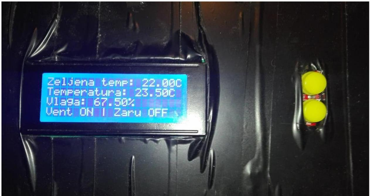
*Slika 3.7. Poklopac razvodne kutije sa LC ekranom i tipkama*
