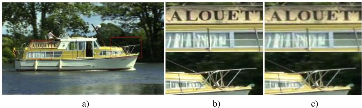
**Sl. 2.12.** Primjer dvostrukog povećanja horizontalne i dvostrukog povećanja vertikalne prostorne rezolucije dijela slike prostorno-vremenskom interpolacijom zasnovanom na samo-sličnosti:
