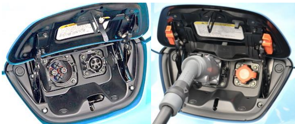
Slika 2.20. Nissan LEAF priključak CHAdeMO (istosmjerna struja) i priključak J1772-2009 (izmjenična struja)
