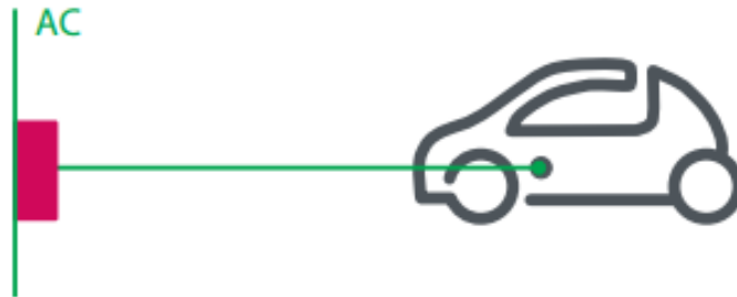
Slika 2.11. Model 1 tip konektora [9]
