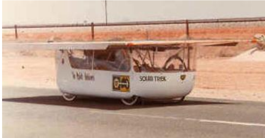
Slika 2.1. Izgled solarnog vozila Quiet Achiever [4]
