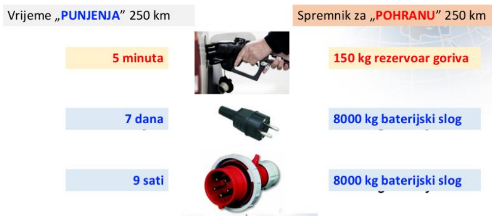
Slika 3.17. Usporedba potrebnog vremena za punjenje vozila energijom potrebnom da vozilo prijeđe put od 250km, te težina spremnika energije
