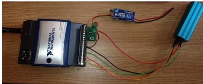
Slika 7.6. ADXL330 akcelerometar spojen sa mjernim čvorom NI WSN – 3202
