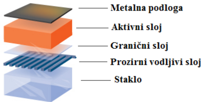
Slika 3.7. Struktura CdTe ćelije [17]
