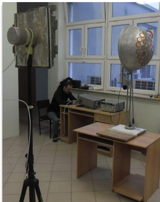
Slika 4.5. Postava za mjerenje dijagrama zračenja antenskog niza.
