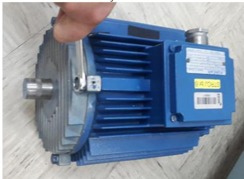
**Slika 4.12.** Skidanje ležajnog štita
