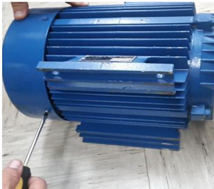
Slika 4.10. Postupak skidanja poklopca ventilatora
