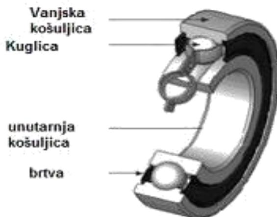
**Slika 2.6.** Prikaz kugličnog ležaja sa sastavnim dijelovima [5]
