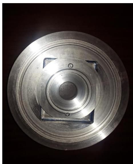
**Slika 5.2.** Prikaz kućišta ležaja unutar ležajnog štita
