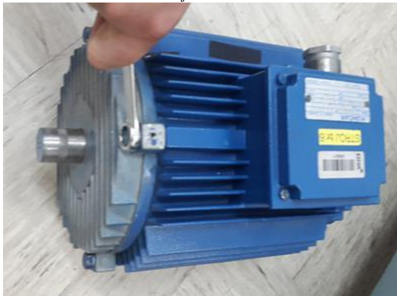
Slika 4.12. Skidanje ležajnog štita
