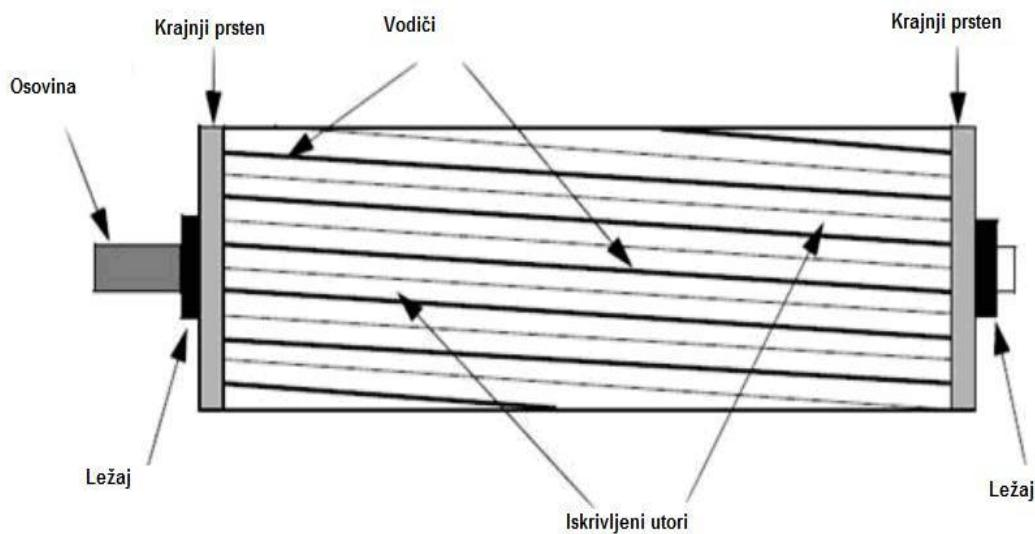
Slika 2.3. Izgled kaveznog rotora [2]
