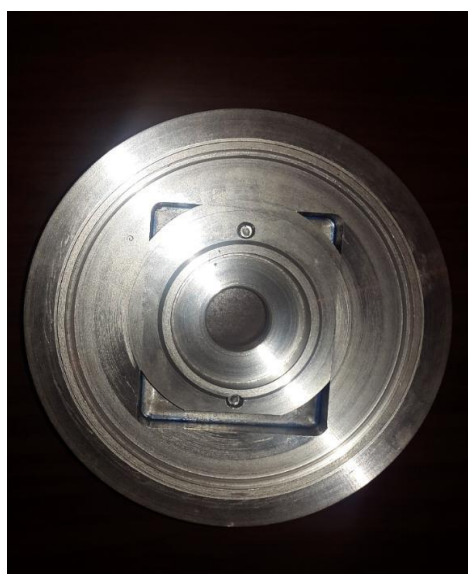
Slika 5.2. Prikaz kućišta ležaja unutar ležajnog štita
