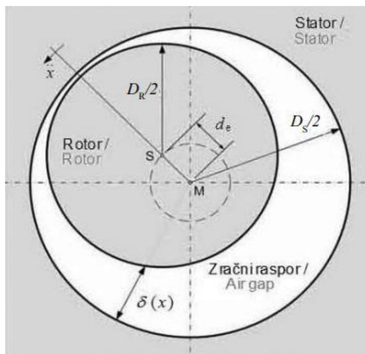
Slika 3.6. Prikaz ekscentričnog pomaka rotora u prvrstu statora. [12]
