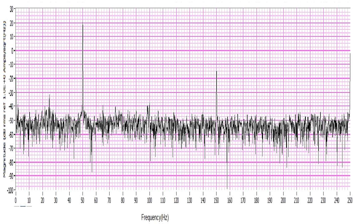
**Slika 5.8.** Amplitudno frekvencijski spektar struje prve faze kada nema ekscentričnog pomaka
