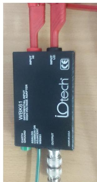
**Slika 5.6.** Naponska mjerna sonda IOTECH WBK61
