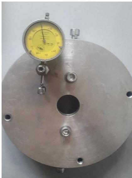
**Slika 5.3.** Ležajni štit prikazan s vanjske strane zajedno s mikrometrom
