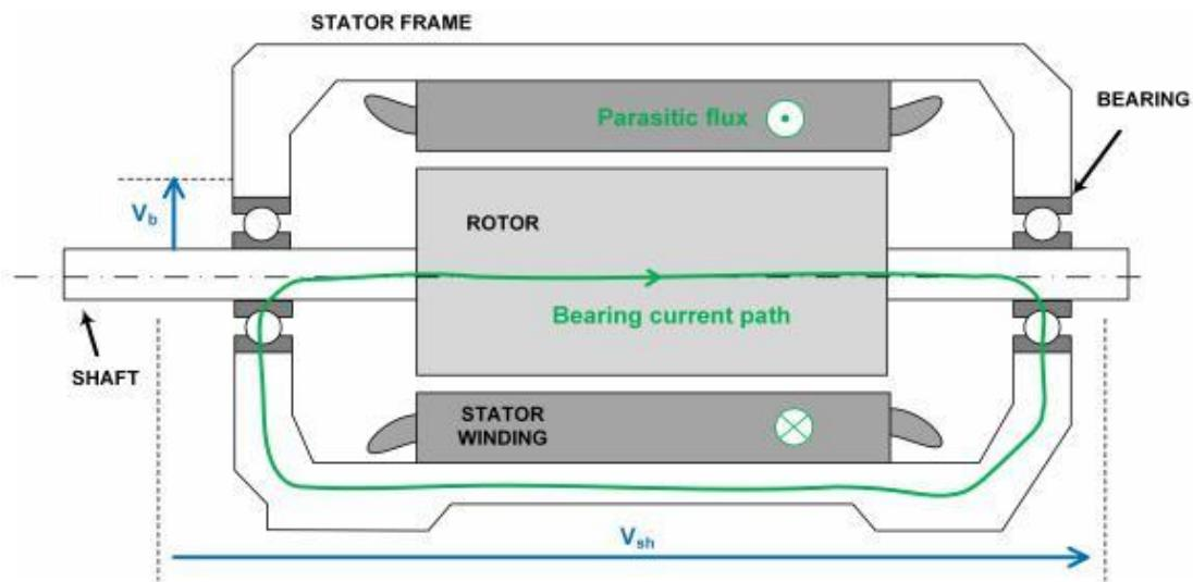
**Slika 3.1.** Tok ležajne struje uzrokovani magnetskom nesimetrijom [8]
