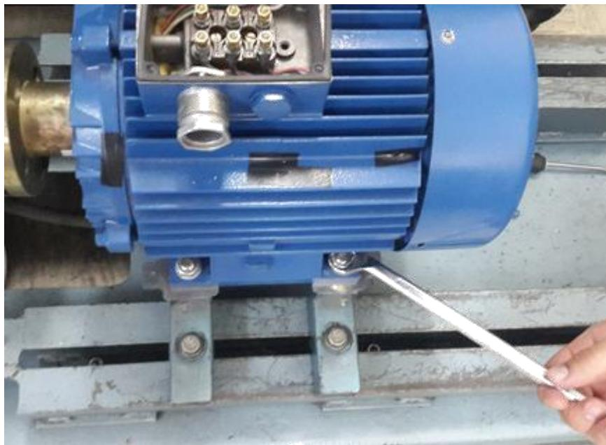
**Slika 4.9.** Skidanje motora s postolja
