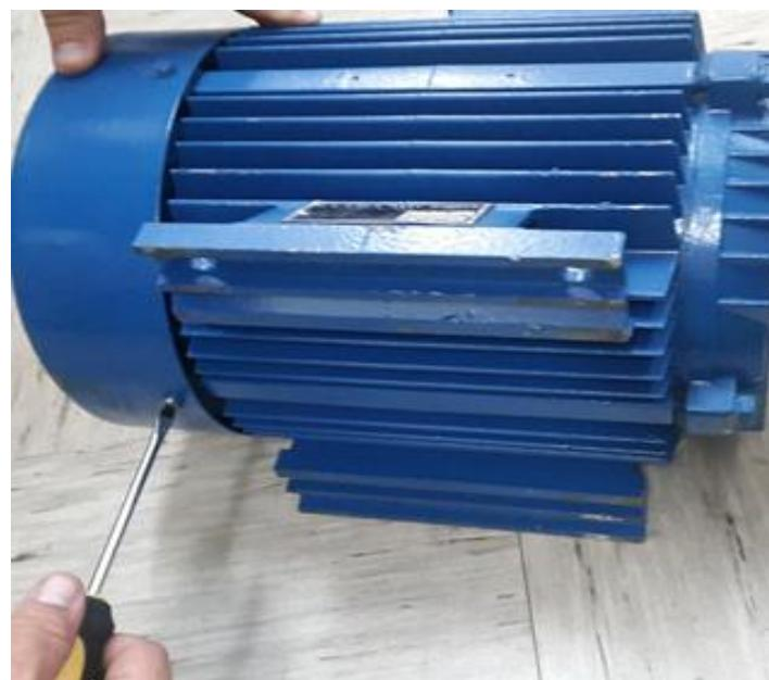
**Slika 4.10.** Postupak skidanja poklopca ventilatora
