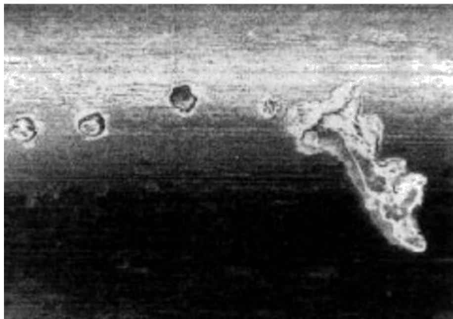
Slika 3.2. Prikaz mikroskopski promatralih oštećenja - engl.pitting [9].
