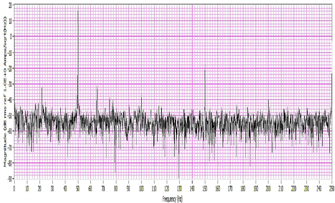
**Slika 5.10.** Frekvenčijski spektar struje prve faze kada je rotor u ekscentričnom pomaku 0.05mm
