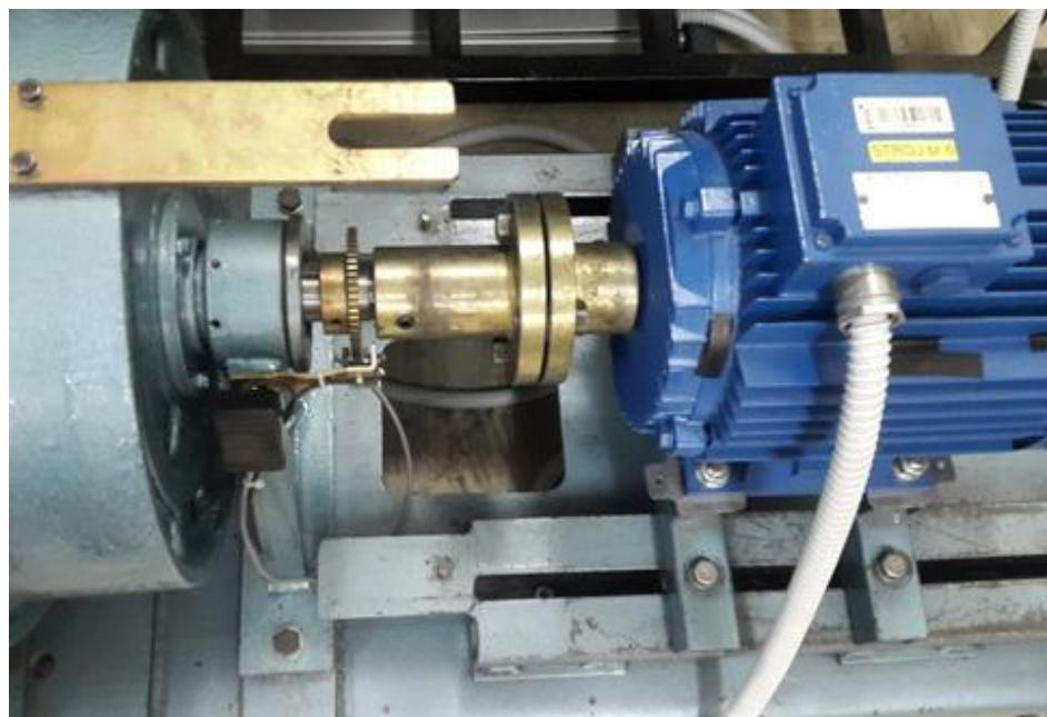
**Slika 4.4.** Spoj istosmjernog generatora i asinkronog motora
