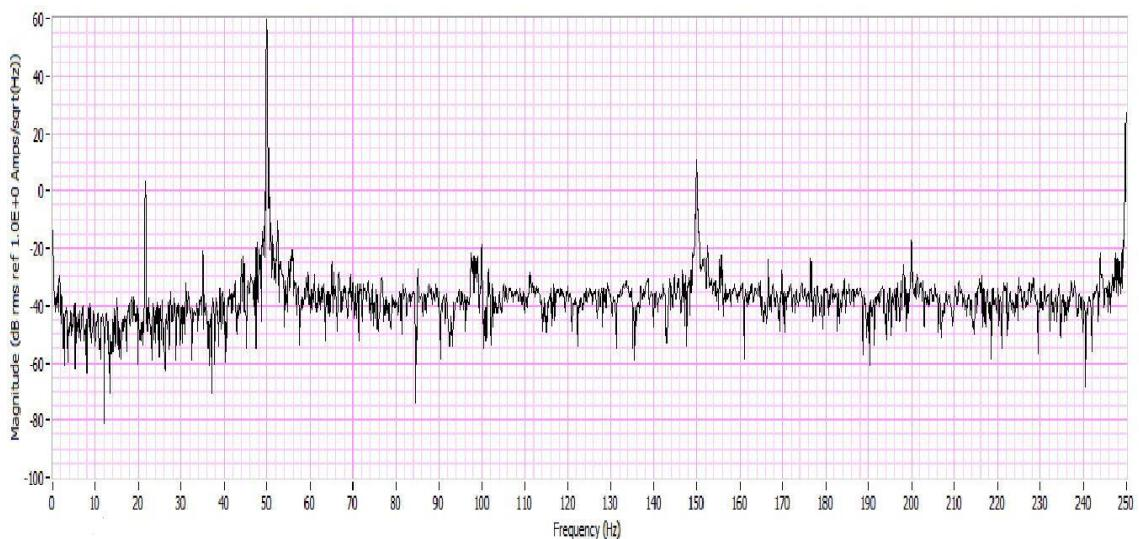
**Slika 5.19.** Frekvencijski spektar napona za ekscentrični pomak 0.05 mm.
