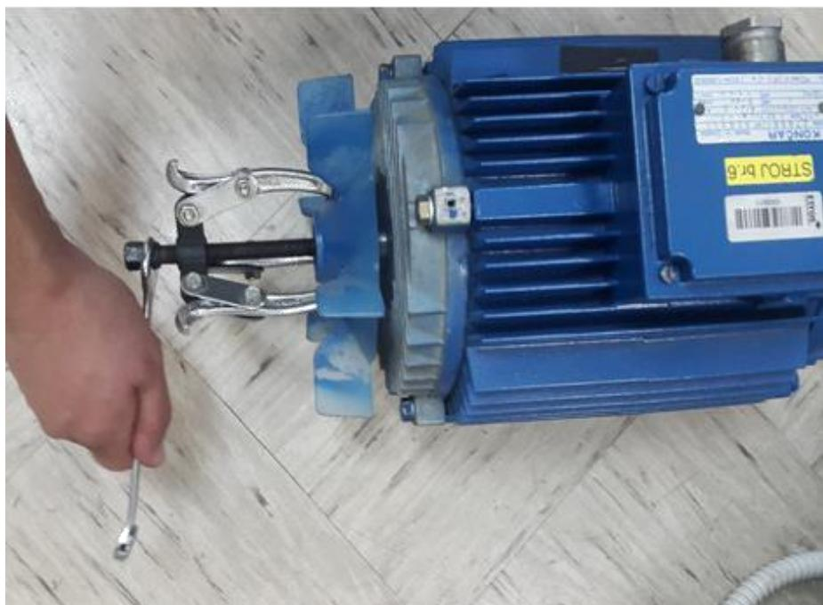
**Slika 4.11.** Skidanje ventilatora s vlastičem
