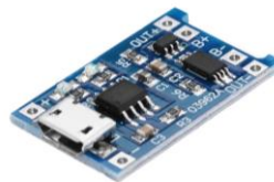
Slika 3.12. TP4056 modul za zaštitu i punjenje baterije.
