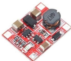
Slika 3.13. Pretvarač sa 1-5 V na 5 V.
