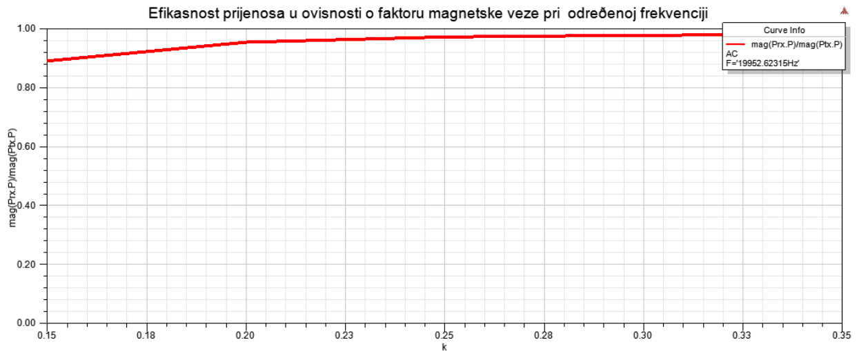
Sl. 5.23. Ovisnost efikasnosti prijenosa o faktoru magnetske veze
