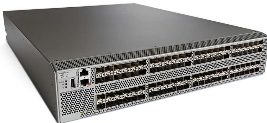
Sl. 3.9. Primjer višeslojnog preklopnika marke Cisco [32]
