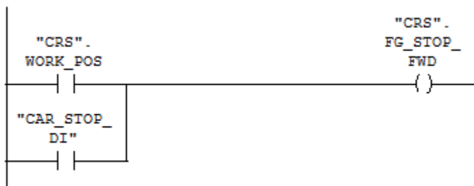
Slika 5.16 Prekid bitovne zastavice za kretanje naprijed
