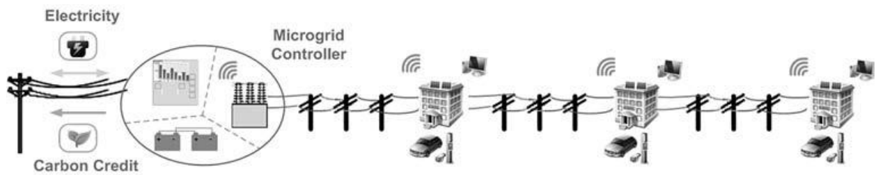
Slika 2.6. Mikromreža na distribucijskom vodu [1]
