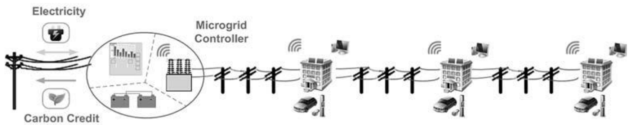
Slika 2.6. Mikromreža na distribucijskom vodu [1]
