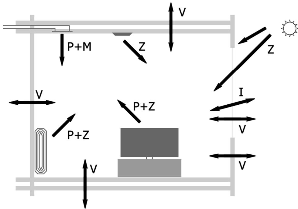
**Slika 2.1.** Tipični toplinski procesi u zgradama ( $V$  – vođenje,  $P$  – prijelaz,  $Z$  – zračenje,  $M$  – tok mase,  $I$  – infiltracija)
