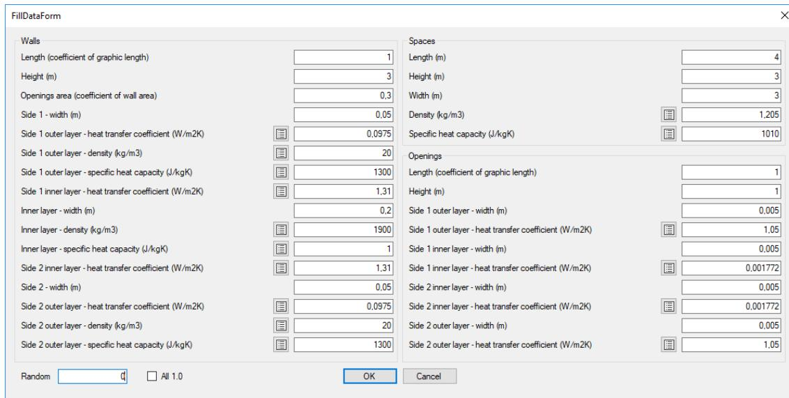
**Slika 3.19.** Mogućnost "Fill parameters..." aplikacije ModelBuilder za podešavanje parametara
