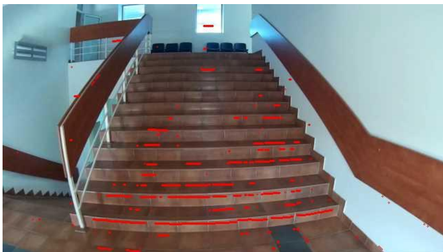
Slika 6.1. Karakteristične rubne točke na stepenicama dobivene vertikalnom morfološkom analizom
