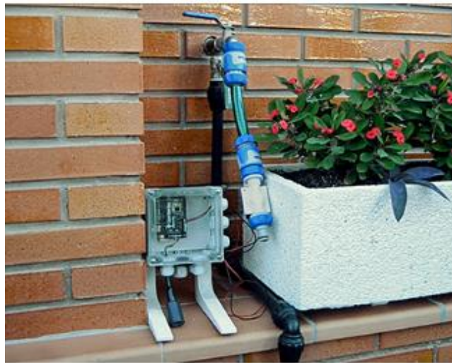
Slika 3.6.Regulator priključen na izvor[2]
