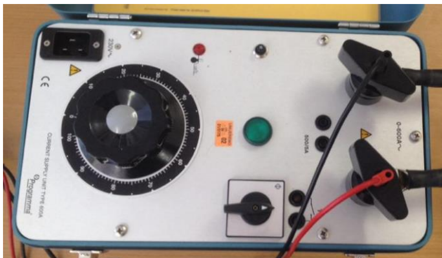
Slika 5.5. Strujni izvor Megger CSU600A/AT
