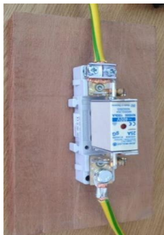
Slika 5.28. Model za ispitivanje HRC osigurača s njegovim nosačem
