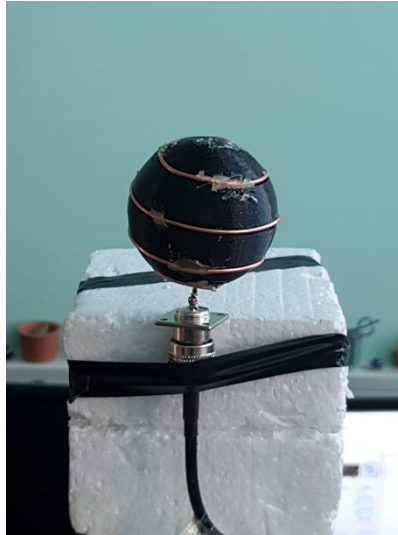
Sl.4.45. Mjerenje jakosti polja u laboratoriju u horizontalnoj ravnini za L8
