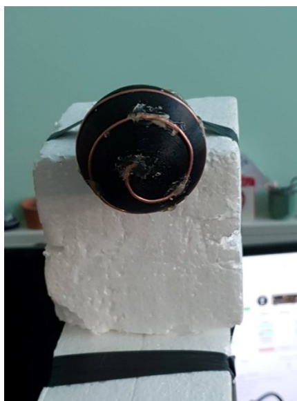
Sl.4.49. Mjerenja jakosti polja u laboratoriju u vertikalnoj ravnini za L8 (POLOŽAJ 2)
