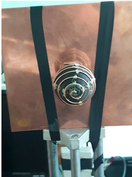
Sl.4.32. Mjerenje jakosti polja u laboratoriju u vertikalnoj ravnini za L5R (POLOŽAJ 2)
