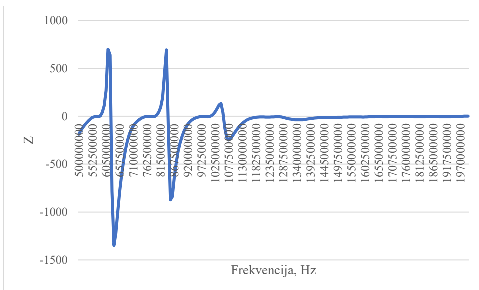
Sl.4.20. Ovisnost imaginarnog dijela impedancije o frekvenciji za antenu L5R.
