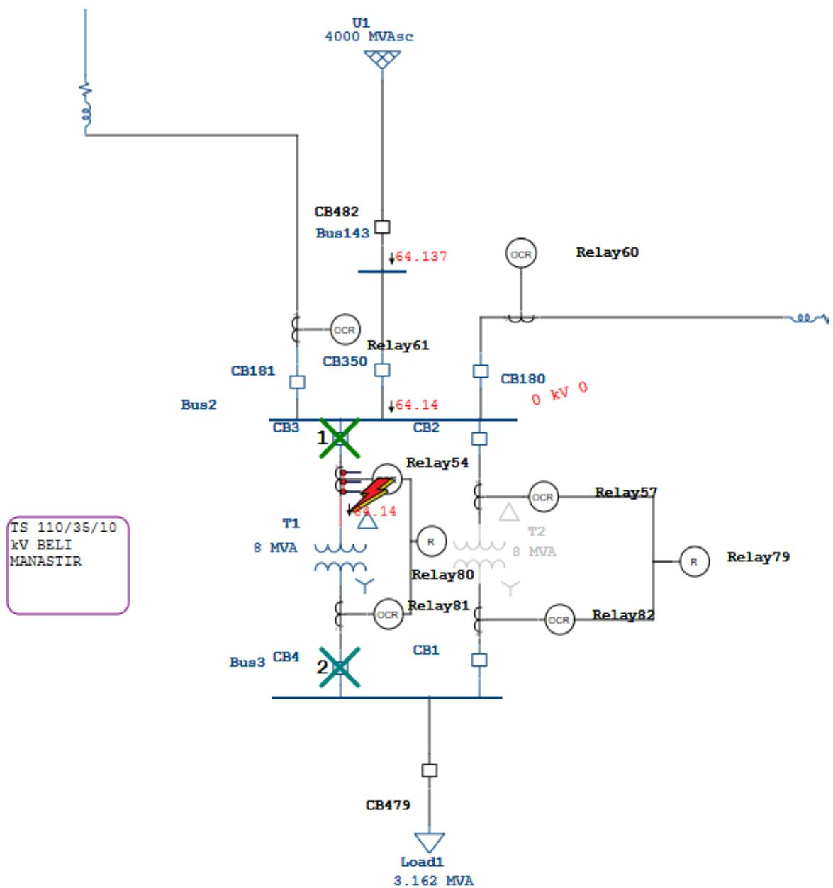
Slika 4.5. Djelovanje diferencijalne zaštite transformatora T1
