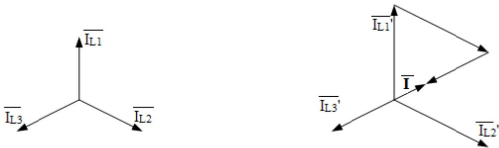
**Slika 2.10.** Vektorski prikaz promjene iznosa struja po fazama [6]
