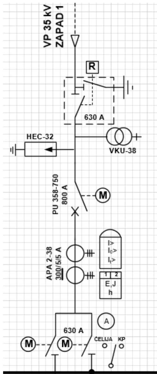
Slika 3.2. Jednopolna shema vodnog polja 35 kV strane
