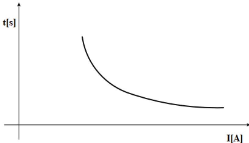
**Slika 2.7.** Strujno-vremenska karakteristika nadstrujnog releja s ovisnom vremenskom karakteristikom[3]
