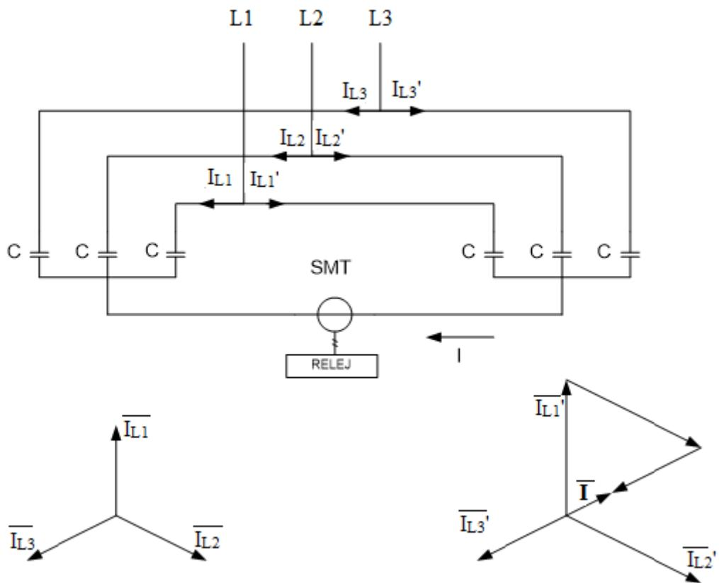
**Slika 2.16.** Shematski i vektorski prikaz balansne zaštite[1]
