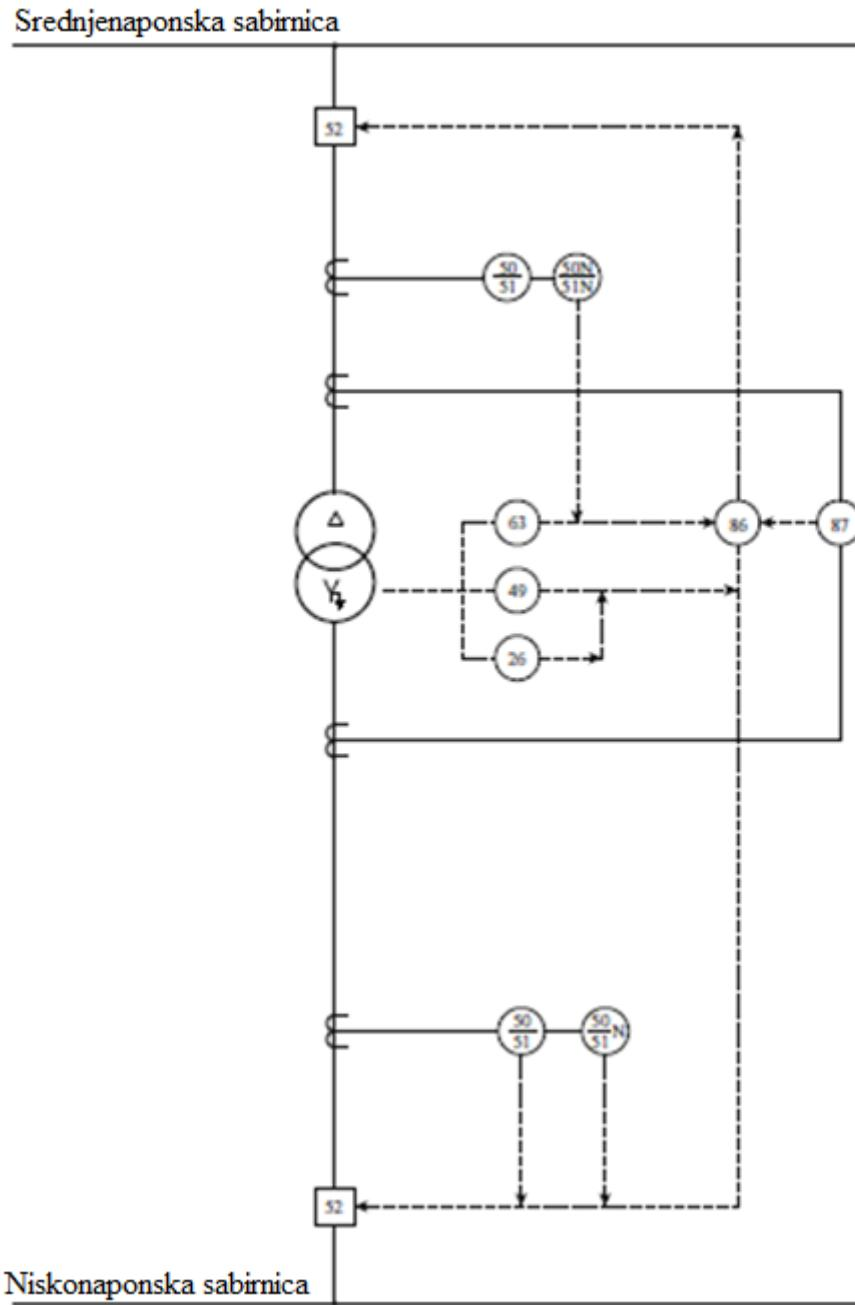
**Slika 3.1.** Sustav zaštite srednjenačinskih i niskonacijskih transformatora [2]
