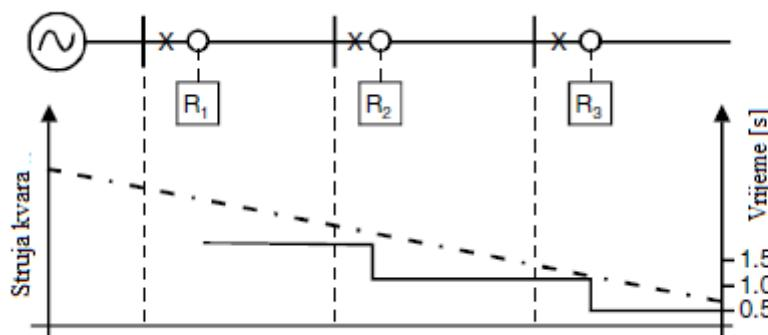
**Slika 3.6. Vremensko stupnjevanje trenutnih nadstrujnih releja [2]**
