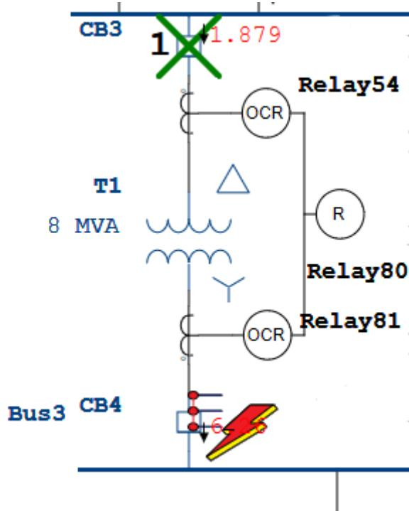
**Slika 2.12.** Kvar izvan zone štićenja diferencijalne zaštite
