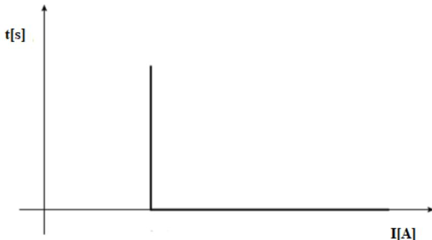
**Slika 2.4.** Strujno-vremenska karakteristika nadstrujnog releja [6]
