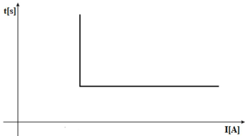
**Slika 2.5.** Strujno-vremenska karakteristika nadstrujnog releja s neovisnom vremenskom karakteristikom [6]
