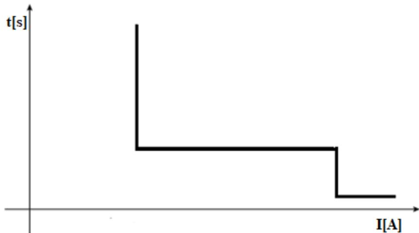
**Slika 2.6.** Strujno-vremenska karakteristika nadstrujnog releja s neovisnom vremenskom karakteristikom i trenutnim vremenskim članom [6]
