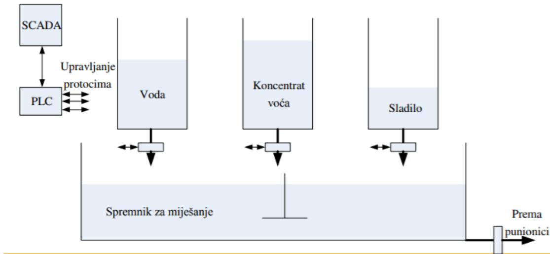
**Sl. 5.3.** Primjer jednog SCADA sustava u industriji proizvodnje soka [42]
