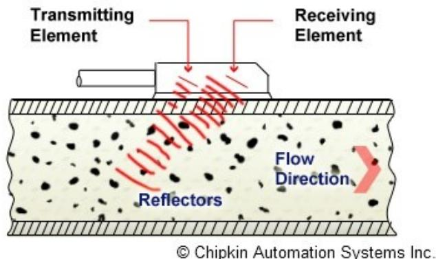
Sl. 3.4. Mjerjenje protoka promjenom frekvencije ultrazvuka [8]
