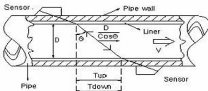
**Sl. 3.1.** Mjerenje protoka preko razlike brzine ultrazvuka [5]
