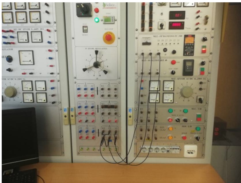
Slika 4.8: Spajanje asinkronog motora na frekvencijski pretvarač
