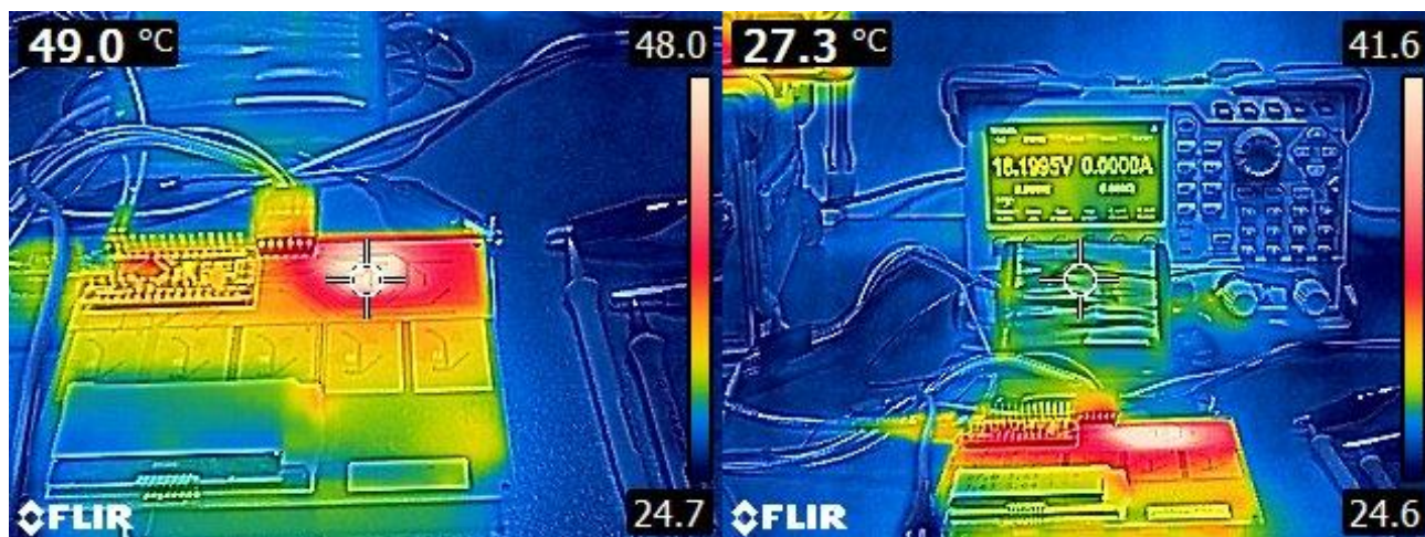
Slika 4.4. Raspodjela temperature sustava i baterije tijekom balansiranja
