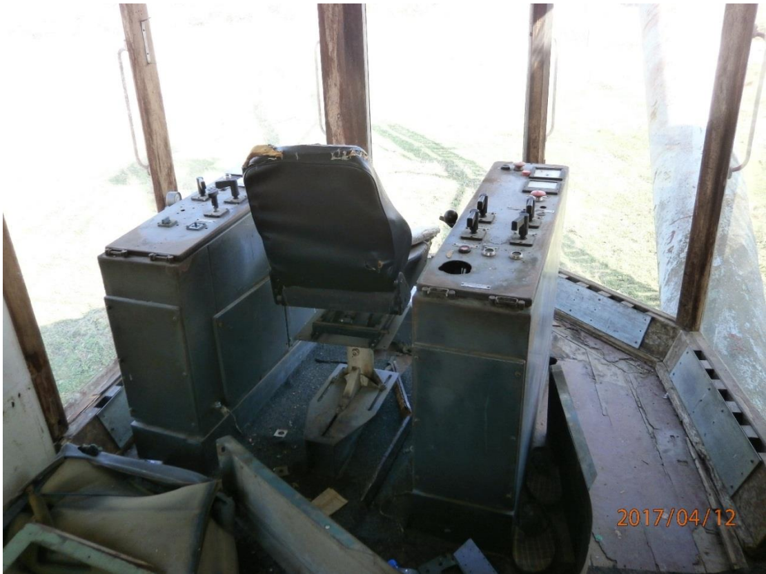
Slika 2.1. Izgled unutrašnjosti upravljačke kabine i komandnih pultova
