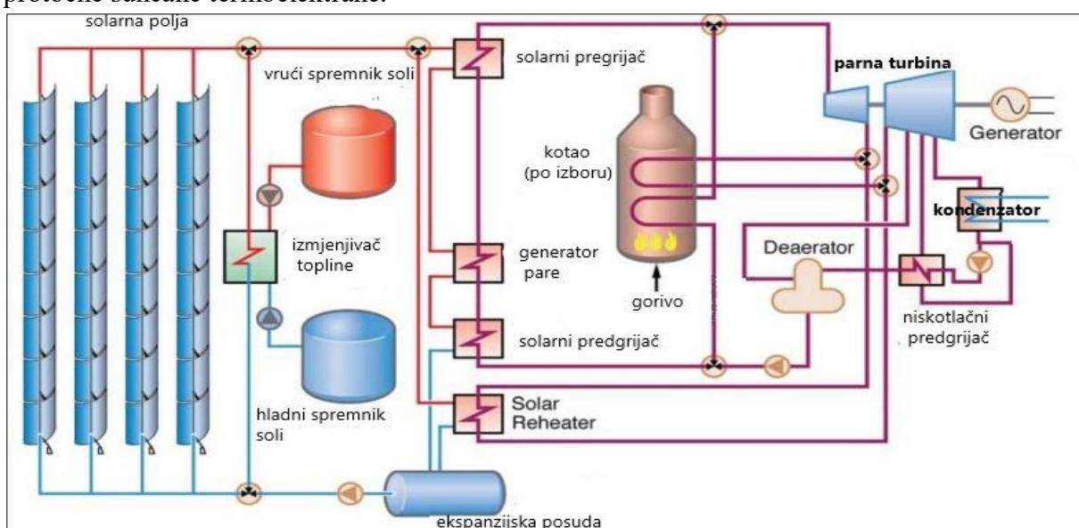
**Slika 2.7.** shematski prikaz rada parabolične protočne solarne termoelektrane [12]
