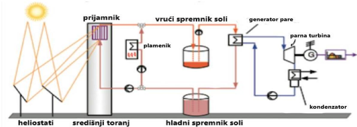
**Slika 2.5.** pojednostavljena shema sunčane termoelektrane sa središnjim prijemnikom
