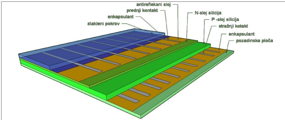
**Slika 3.1.** dijelovi fotonaponske čelije [1]
