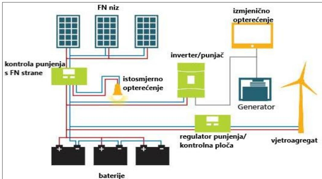
**Slika 5.5.** Pojednostavljeni prikaz autonomnog fotonaponskog hibridnog sustava s vjetroagregatom i elementima koji su potrebni za pravilno funkciranje ovakvog sustava [7]
