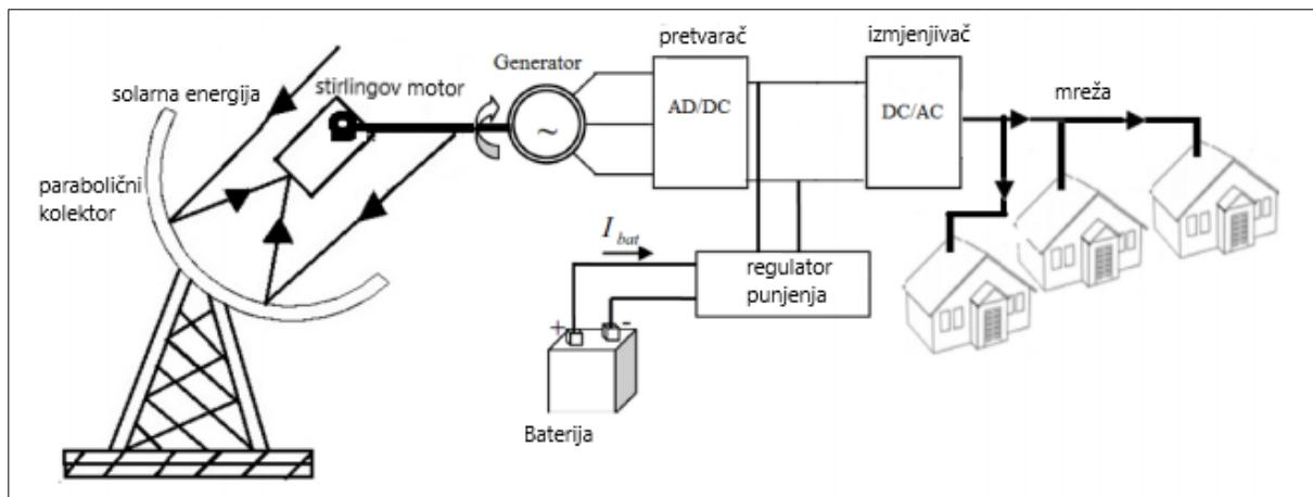
**Slika 2.6.** princip rada solarne termoelektrane s paraboličnim tanjurom [4]
