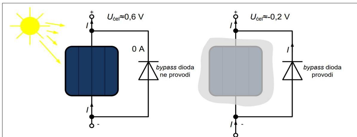
Slika 4.4. primjer spajanja bypass diode na FN čeliju i prikaz njenog provođenja [1]
