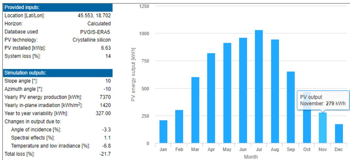
**Slika 6.7.** prikaz proizvodnje nadomjesne elektrane Jug instalirane snage 6,63 kWp s vrijednostima ukupne godišnje proizvodnje i gubitaka s obzirom na temperaturu i smanjenu iradijaciju. Istaknuta je vrijednost proizvodnje u studenom.
