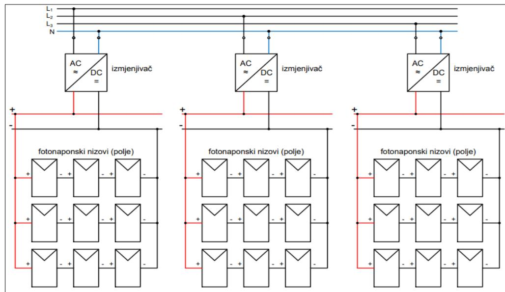
Slika 5.3. shematski prikaz fotonaponske elektrane s više izmjenjivača [1]
