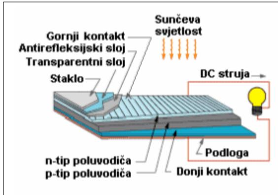
Slika 3.4. struktura c-Si ćelije [5]
