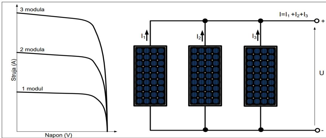
**Slika 4.3.** paralelno spojen string i strujno naponska karakteristika [1]
