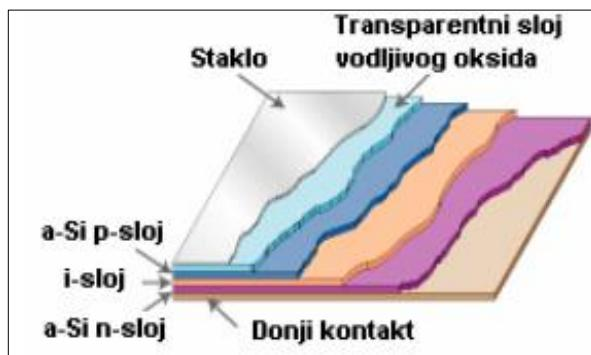
Slika 3.5. struktura ćelije od amorfognog silicija [5]
