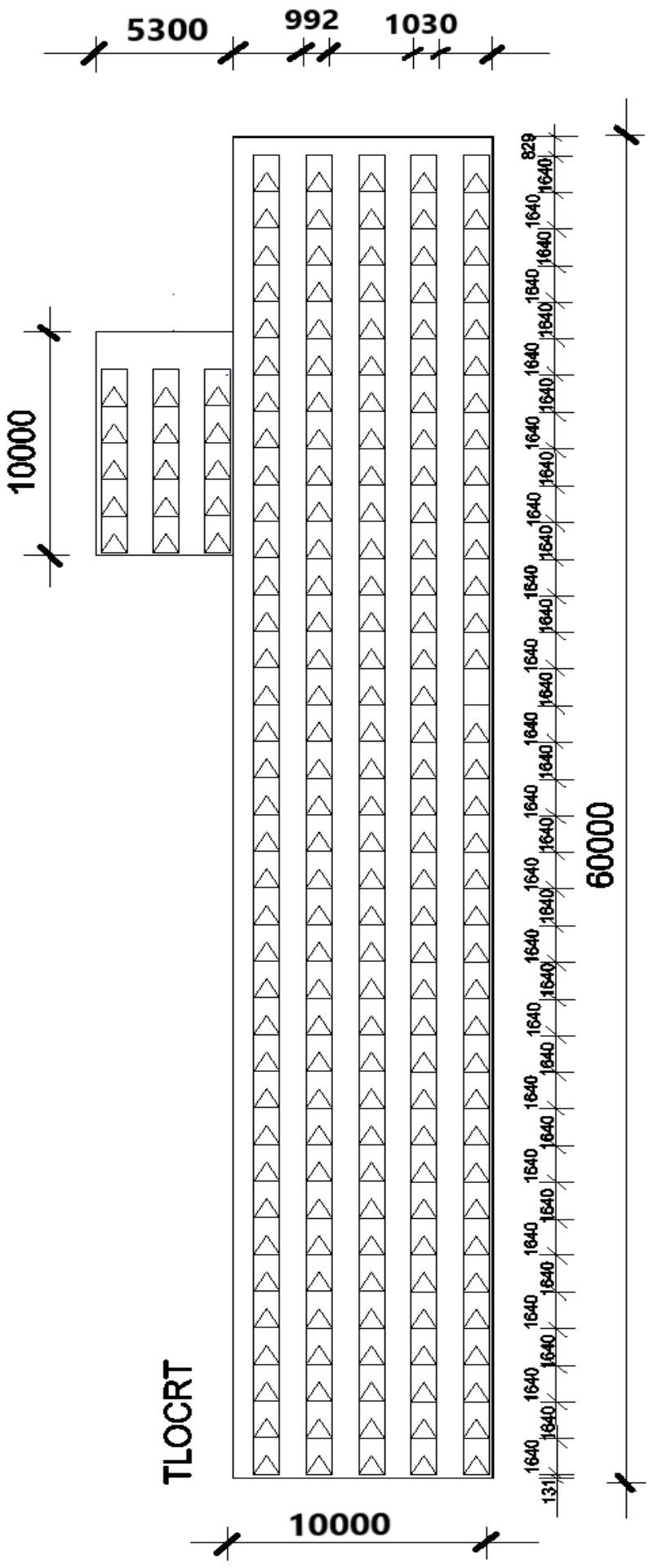
Slika 6.10. tlocrt objekta na kojem je smještena elektrana sa prikazanim fotonaponskim nizovima
