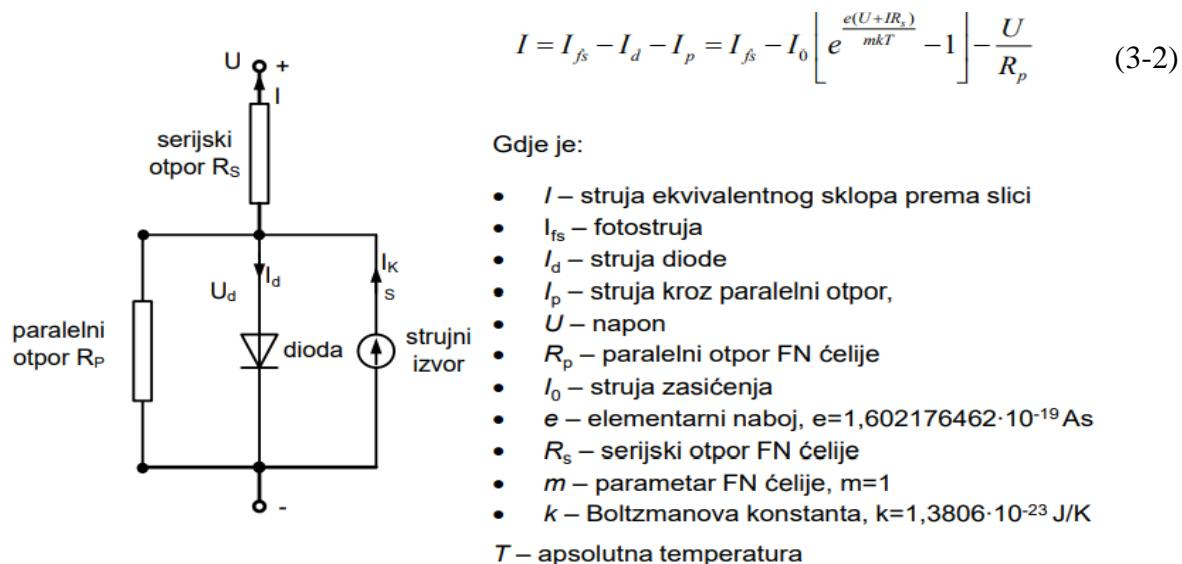
**Slika 3.2.** dijelovi nadomjesne sheme, izraz za struju FN čelije [1]
