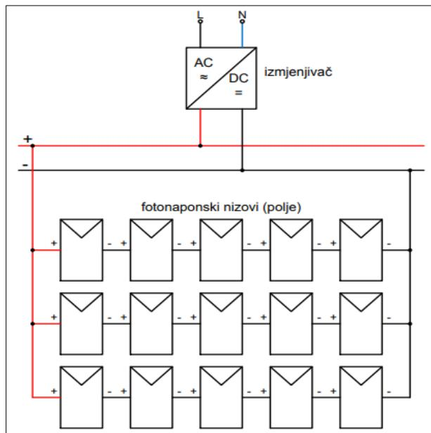
Slika 5.1. shematski prikaz FN elektrane s jednim izmjenjivačem [1]
