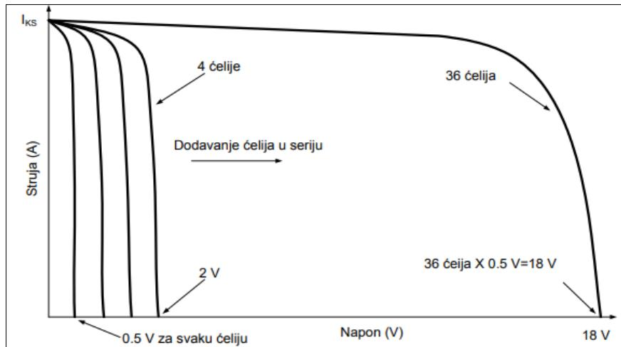
**Slika 4.1.** strujno naponska karakteristika FN modula sačinjenog od 36 FN ćelija [1]
