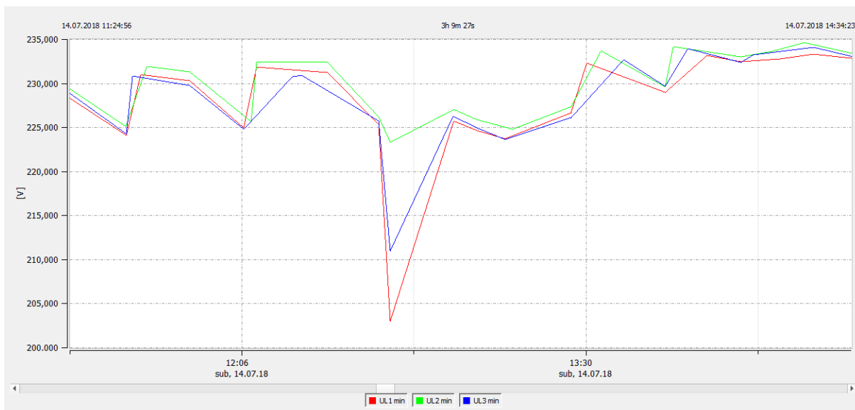
Slika 4.25. Naponski propad u fazi L1(14.7.2018. u 12:42:34)
