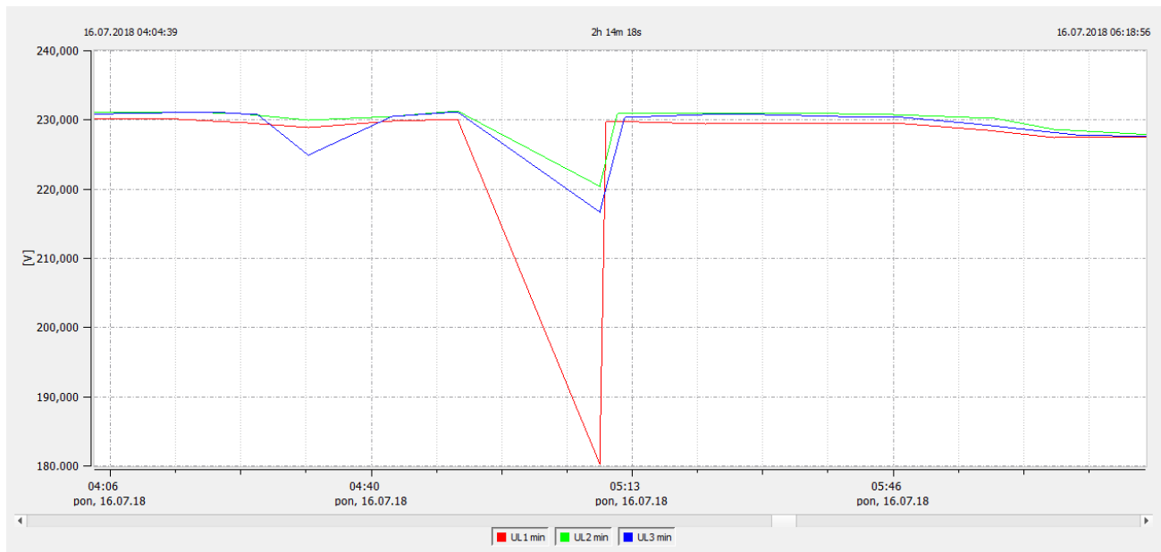
Slika 4.27. Naponski propad u fazi L1(16.7.2018. u 05:09:14)
