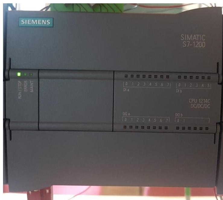
Slika 3.1. SIMATIC CPU S7-1214 DC/DC/DC
