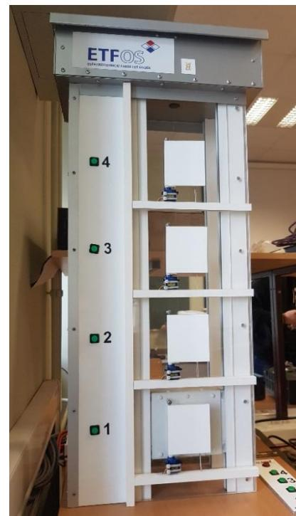
Slika 3.13. Vertikalni stup makete dizala
