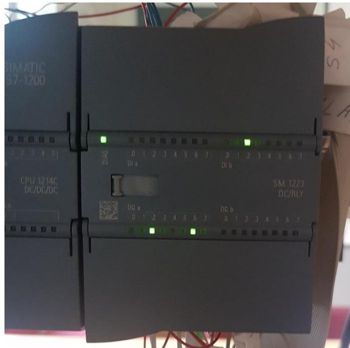
Slika 3.2. Ulazno/izlazna jedinica SM 1223 DC/RLY
