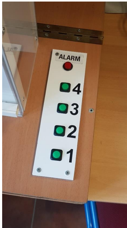
Slika 3.14. Upravljačka ploča makete dizala
