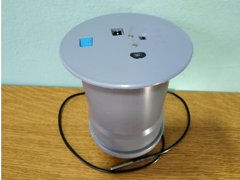
Sl. 3.21. Gornja strana kućišta koja se ugrađuje izvan spremnika.
