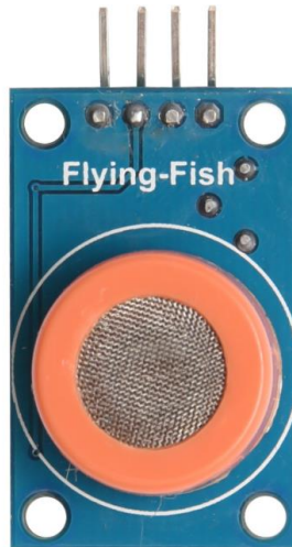
Sl. 3.6. MQ3 Senzor plinova [12].
