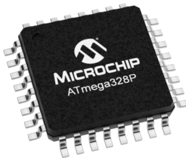
Sl. 3.3. ATmega328p mikroupravljač [9].
