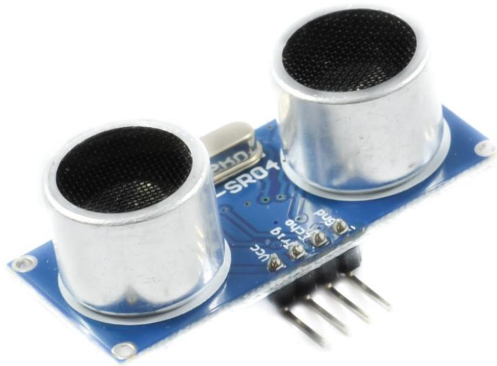
Sl. 3.11. Senzor za mjerenje udaljenosti HC-SR04 [16].
