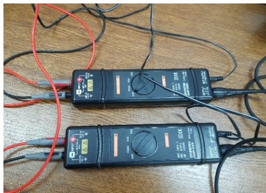
SI 3.4. Prikaz diferencijalnih sondi GW INSTEK GDP-025
